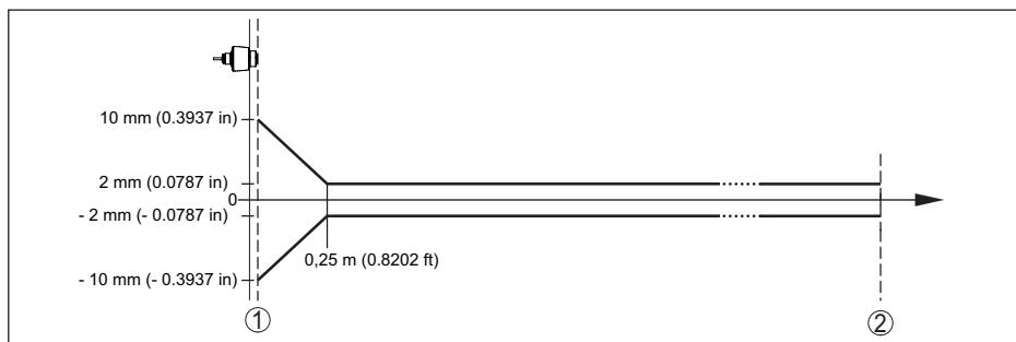
插图. 29: 在基准条件下的测量偏差 <sup>11)</sup>
