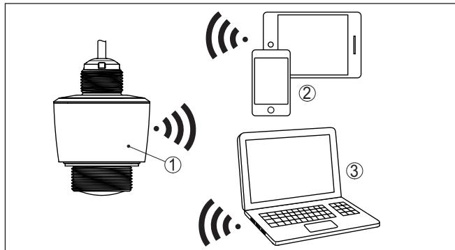
插图. 3: 与带有内置蓝牙 LE 的标准调整工具实现无线连接
