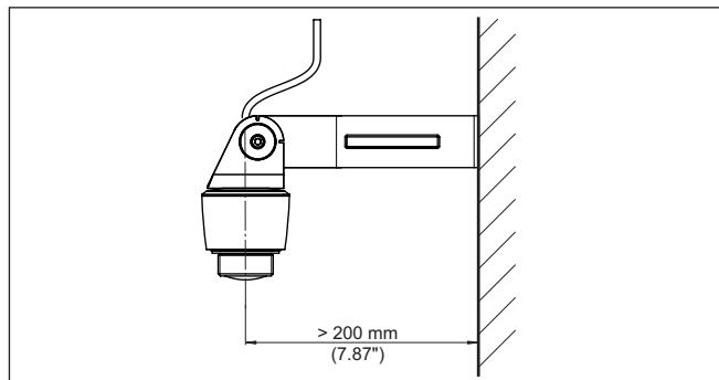
插图. 5: 通过一个安装角形件进行安装
