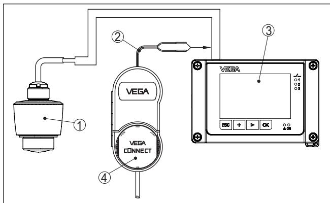
插图. 24: 将电脑与 VEGAMET 型控制器相连接
