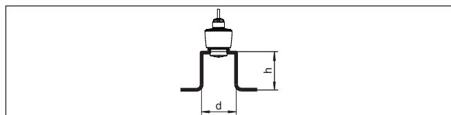
插图. 12: 当管接头的尺寸有别时管接头的安装
