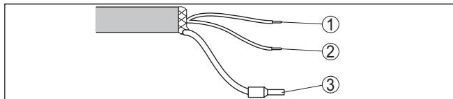
插图. 18: 固定连接的连接电缆的芯线分布
