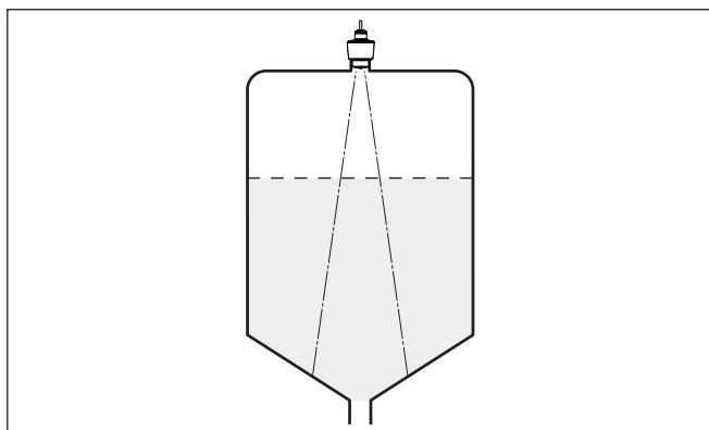
插图. 8: 将雷达传感器安装到带有锥形底部的容器上
