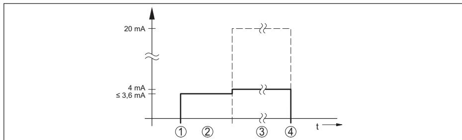
插图 28: 启动时间和测量值的输出
