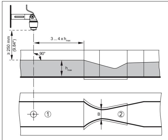
插图. 17: 用卡发基-文丘里槽来测量流量 :  $h_{\max}$  = 水槽的最大灌装量 ; B = 水槽的最大收缩率
