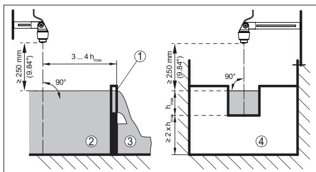
插图. 16: 用矩形槽测量流量 :  $h_{\max} =$  矩形槽的最大注水高度
