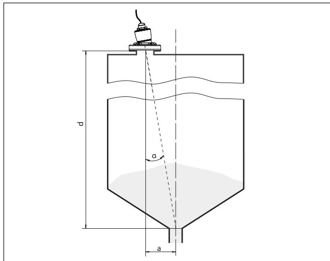
插图. 16: 校准 VEGAPULS C 21 后的安装建议
