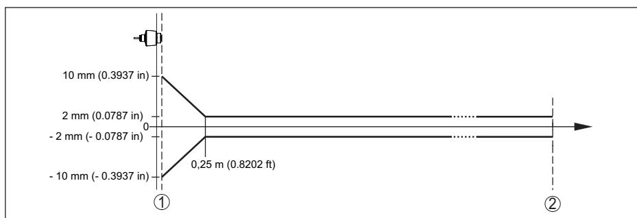
插图. 31: 在基准条件下的测量偏差<sup>11)</sup>
