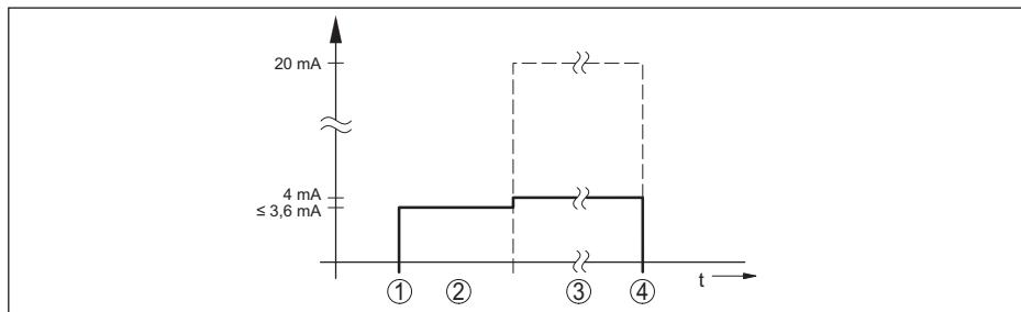
插图 30: 启动时间和测量值的输出
