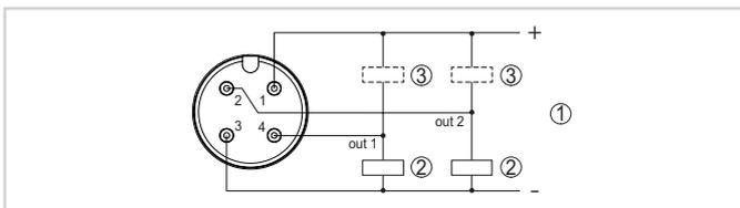
Schema di collegamento connettore M12 x 1 - uscita a transistor, trifilare
