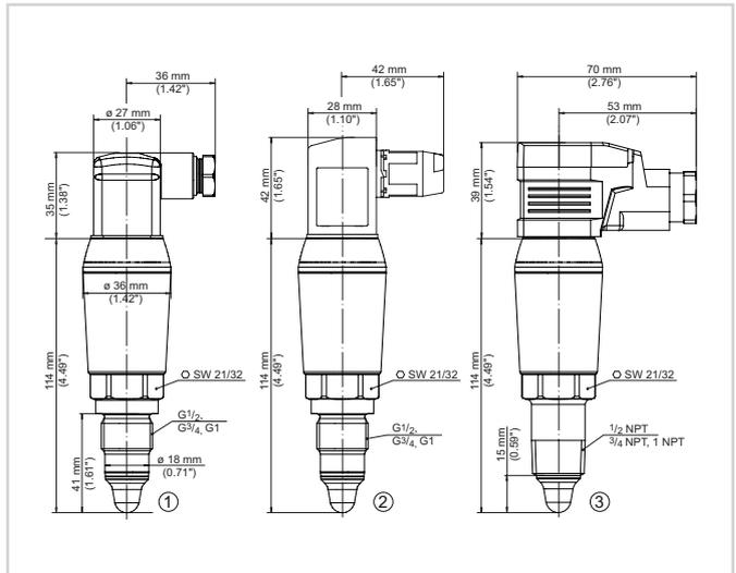
VEGAPOINT 21, esecuzione standard - filettatura con connettore a valvola secondo ISO 4400
