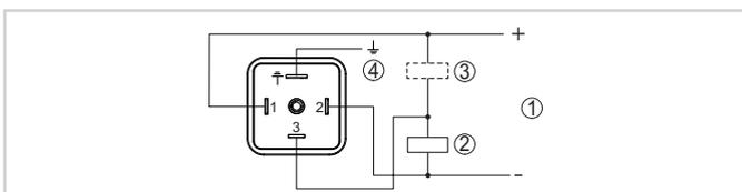
Schema di collegamento connettore ISO 4400 - uscita a transistor, trifilare
