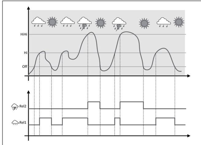
Abb. 17: Beispiel einer Pumpensteuerung mit Option "Schönwetterbetrieb"
