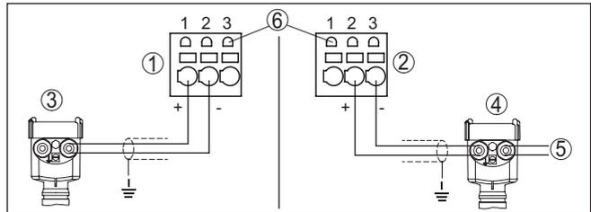
Abb. 7: Anschluss Eingang 1 für Zweileiter-/Vierleitersensor (aktiv/passiv)
