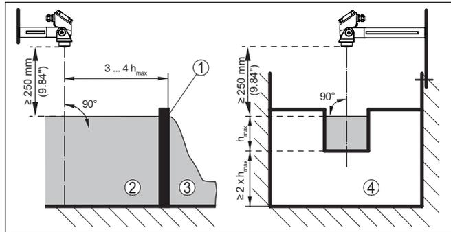
Abb. 20: Durchflussmessung mit Rechtecküberfall:  $h_{\text{max}} = \text{max. Befüllung des Rechtecküberfalls}$
