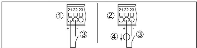
Abb. 9: Anschlussbelegung der Digitaleingänge (aktiv/passiv)
