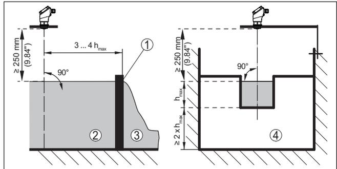
Abb. 22: Durchflussmessung mit Rechtecküberfall:  $h_{\text{max}}$  = max. Befüllung des Rechtecküberfalls
