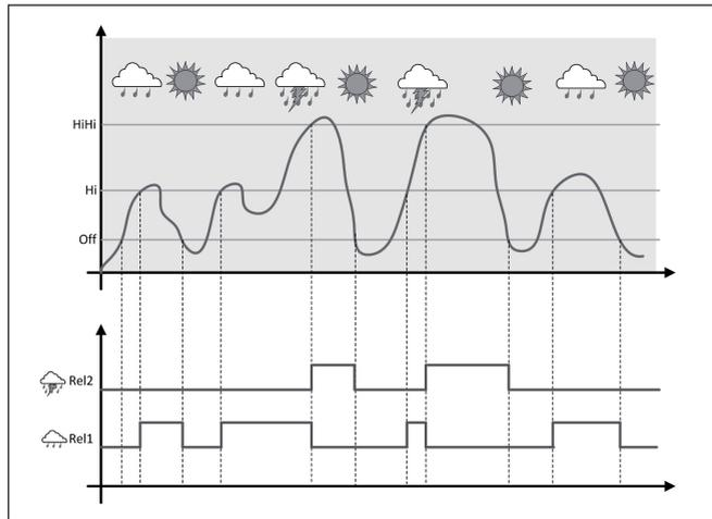
Abb. 21: Beispiel einer Pumpensteuerung mit Option "Schönwetterbetrieb"
