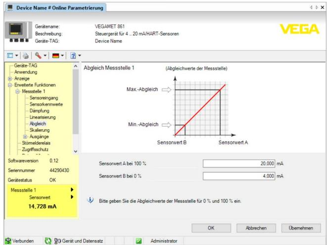
Abb. 14: Beispiel einer DTM-Ansicht - Abgleich
