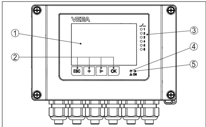
Abb. 10: Anzeige- und Bedienelemente
