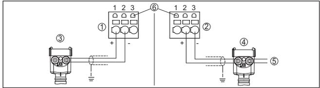
Abb. 7: Anschluss Eingang 1 für Zweileiter-/Vierleitersensor (aktiv/passiv)
