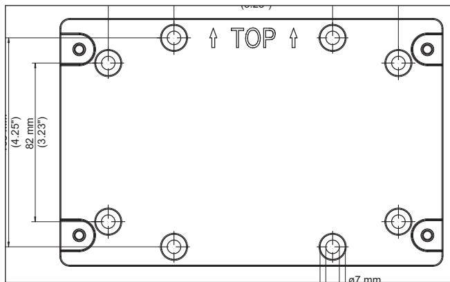
插图. 3: 用于壁挂式安装的安装板 VEGAMET 861
