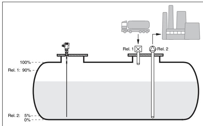
插图. 15: 举例说明对卧式圆形槽罐的物位测量
