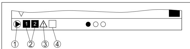
插图. 17: 泵控制激活情况下的显示器状态条举例
