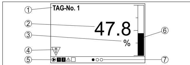
插图. 11: 测量值显示窗口举例 (用柱状图显示测量值)
