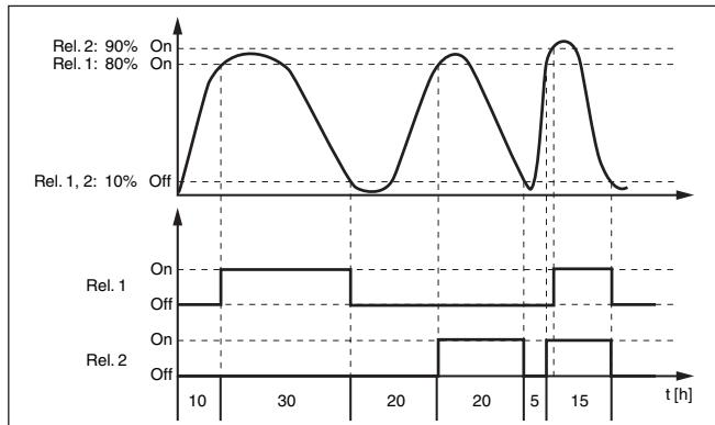
插图. 18: 示例 : 泵控制器 2
