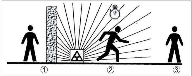
Fig. 3: Mesures de protection contre le rayonnement radioactif
