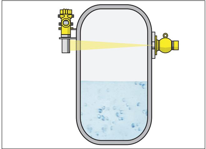
Fig. 7: POINTRAC 31 comme détection du niveau maximal (émergé)
