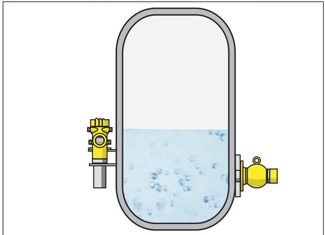
Fig. 8: POINTRAC 31 comme détection du niveau minimal (immérgé)
