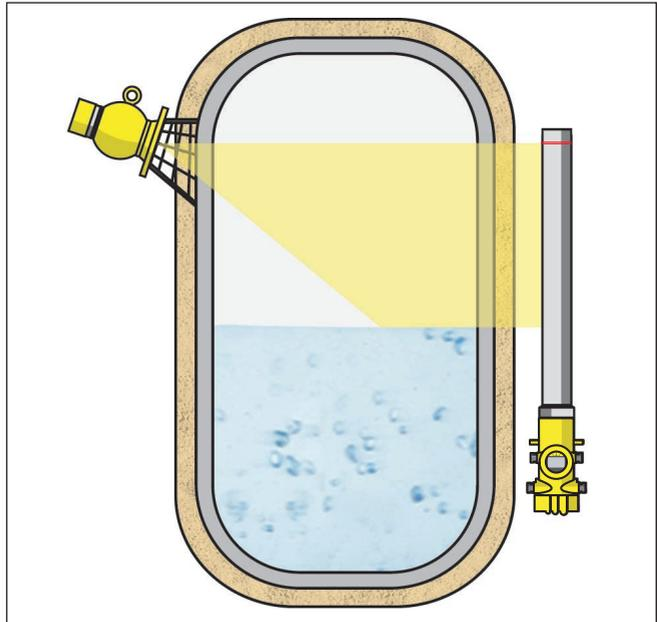
Abb. 7: Füllstandmessung an einem beheizten Behälter mit Wärmeisolierung
