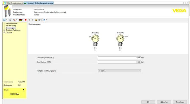
Abb. 28: Beispiel einer DTM-Ansicht - Abgleich Stromausgang
