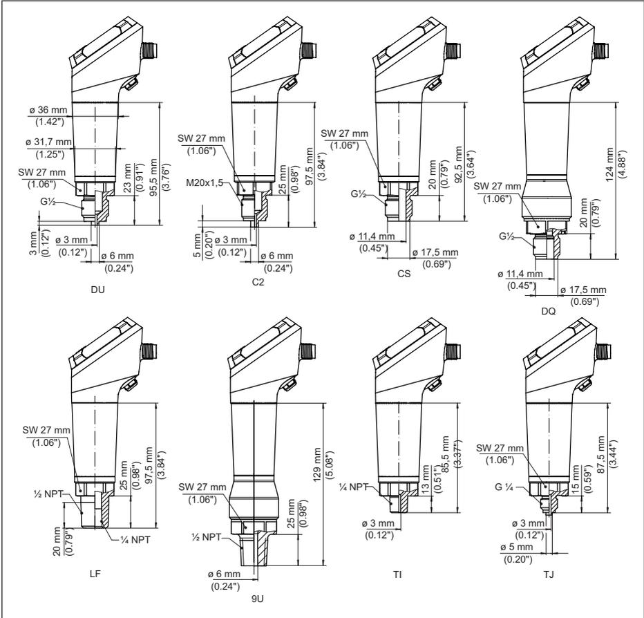
Abb. 35: VEGABAR 38, Gewindeanschluss nicht frontbündig
