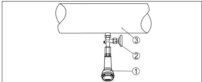
Abb. 13: Messanordnung bei Prozessdruckmessung von Flüssigkeiten in Rohrleitungen
