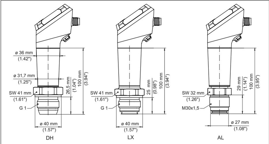
Abb. 37: VEGABAR 38, Konus-/Tubusanschluss
