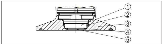
Abb. 7: Hygienischer Einbau der Messzelle (Beispiel: Clamp 2")
