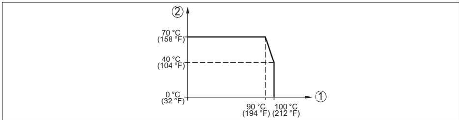
Abb. 33: Temperaturderating VEGABAR 38, bei aktivierter Bluetooth-Kommunikation
