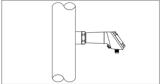
Abb. 3: Prozessdruckmessung mit VEGABAR 38
