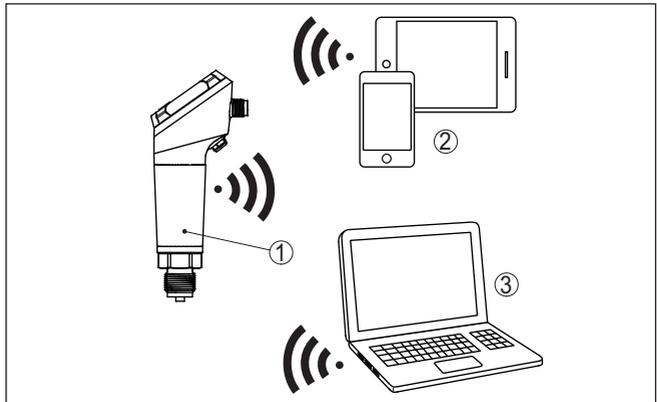
Abb. 8: Drahtlose Verbindung zu Standard-Bediengeräten mit integriertem Bluetooth LE
