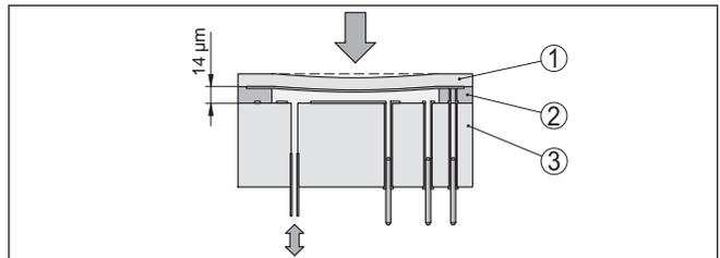
Abb. 4: Aufbau der Mini-CERTEC®-Messzelle
