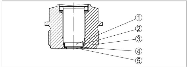
Abb. 6: Frontbündiger Einbau der Messzelle (Beispiel: Gewinde G1 $\frac{1}{2}$ )
