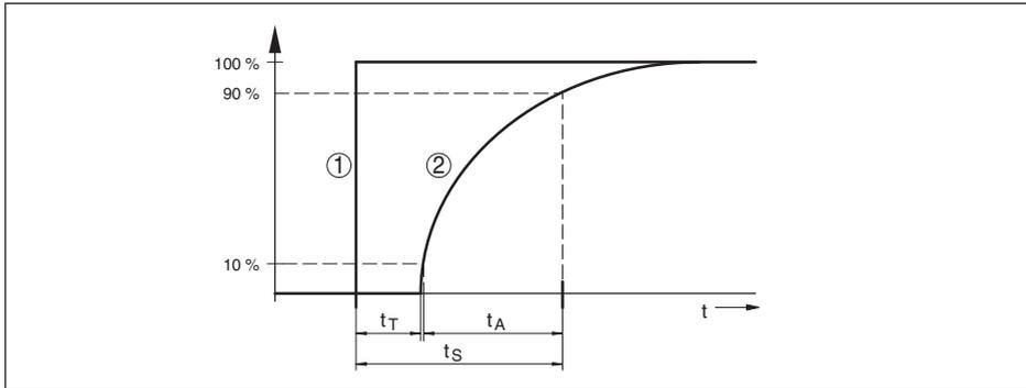
Abb. 30: Verhalten des Stromausganges bei sprunghafter Änderung der Prozessgröße.  $t_T$ : Totzeit;  $t_A$ : Anstiegszeit;  $t_S$ : Sprungantwortzeit
