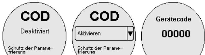
Bei geschützter Parametrierung können die einzelnen Menüpunkte zwar angewählt und angezeigt, die Parameter jedoch nicht mehr geändert werden.
