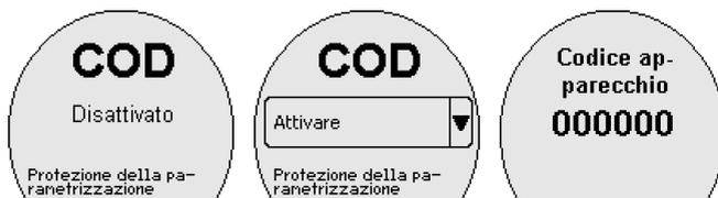
In caso di protezione della parametrizzazione è possibile selezionare e visualizzare le singole voci di menu, ma non modificare i parametri. È possibile sbloccare nuovamente la calibrazione del sensore in qualsiasi voce del menu inserendo il codice apparecchio. La parametrizzazione rimane sbloccata fino al ritorno all'indicazione del valore di misura. Questo avviene automaticamente dopo 60 min.
