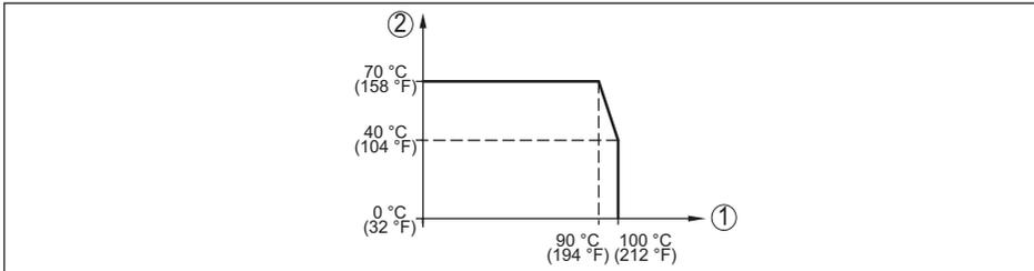
Abb. 28: Temperaturderating VEGABAR 29, bei aktivierter Bluetooth-Kommunikation
