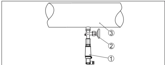
Abb. 11: Messanordnung bei Prozessdruckmessung von Flüssigkeiten in Rohrleitungen
