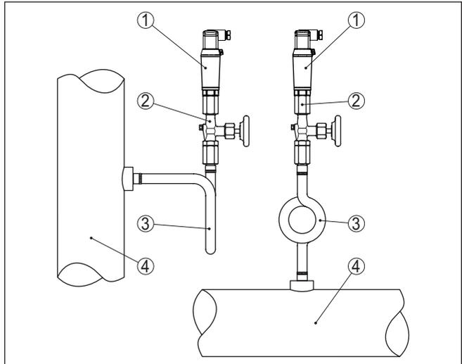
Abb. 10: Messanordnung bei Prozessdruckmessung von Dämpfen in Rohrleitungen
