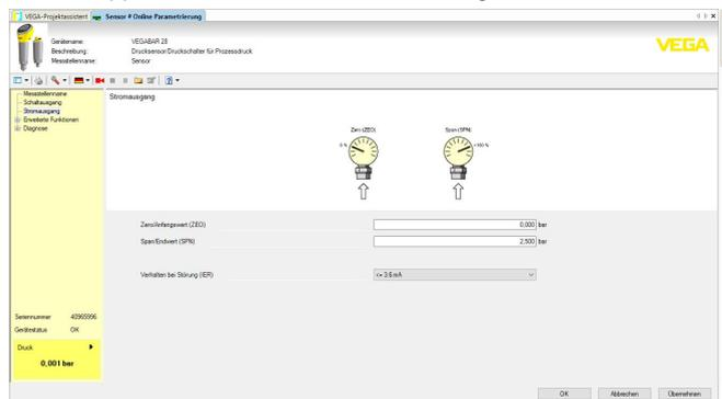
Abb. 23: Beispiel einer DTM-Ansicht - Abgleich Stromausgang
