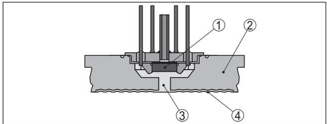
Abb. 4: Aufbau des Messsystems mit piezoresistivem Sensorelement
