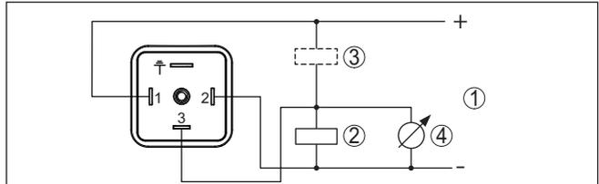
Abb. 18: Anschlussplan - Dreileiter 1 x Transistor oder 4 ... 20 mA
