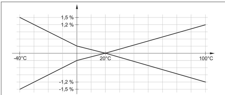
Abb. 26: Temperaturfehler bei TD 1 : 1
