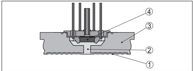
Abb. 4: Aufbau des Messsystems mit piezoresistivem Sensorelement
