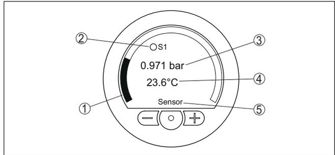
Abb. 20: Messwert, Schaltzustand und zusätzliche Daten (Beispiel Elektronik A und C)
