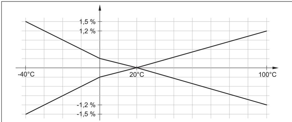
Abb. 32: Temperaturfehler bei TD 1 : 1
