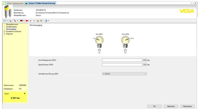
Abb. 29: Beispiel einer DTM-Ansicht - Abgleich Stromausgang
