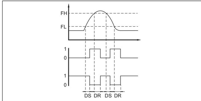
Abb. 25: Auswirkung der Verzögerungszeit auf den Ausgang bei Fensterfunktion
