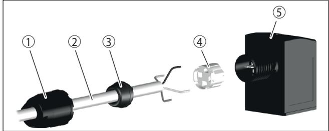
Abb. 17: Anschluss Ventilstecker ISO 4400 mit Schneidklemmtechnik
