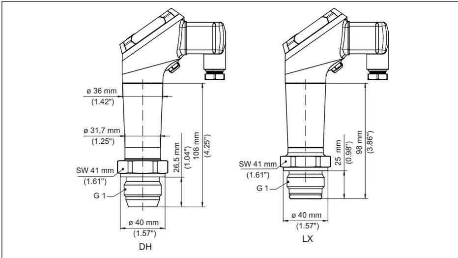
Abb. 38: VEGABAR 39, Konus-/Tubusanschluss
