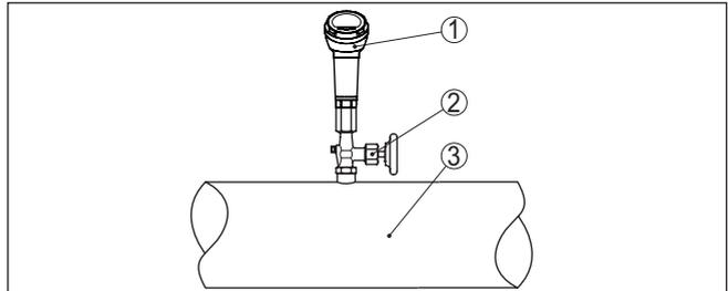
Abb. 9: Messanordnung bei Prozessdruckmessung von Gasen in Rohrleitungen
