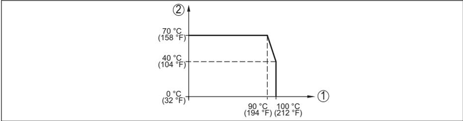
Abb. 34: Temperaturderating VEGABAR 39, bei aktivierter Bluetooth-Kommunikation
