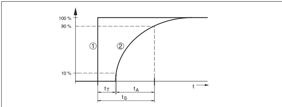
Abb. 31: Verhalten des Stromausganges bei sprunghafter Änderung der Prozessgröße.  $t_T$ : Totzeit;  $t_A$ : Anstiegszeit;  $t_S$ : Sprungantwortzeit
