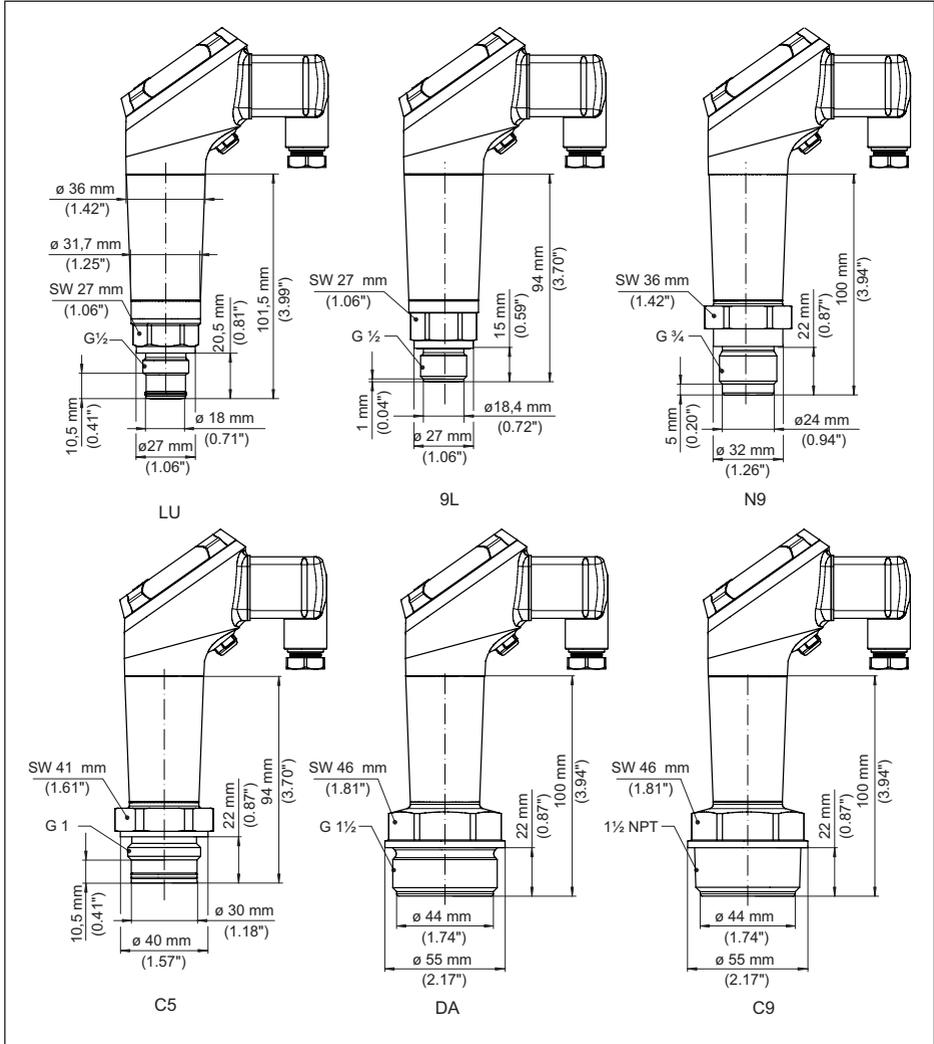
Abb. 37: VEGABAR 39, Gewindeanschluss frontbündig
