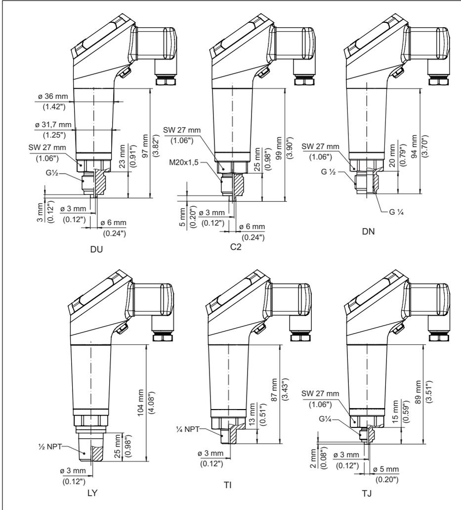
Abb. 36: VEGABAR 39, Gewindeanschluss nicht frontbündig
