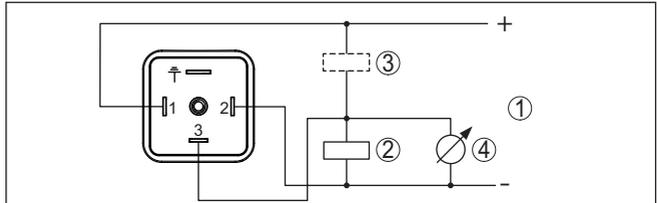
Abb. 18: Anschlussplan - Dreileiter 1 x Transistor oder 4 ... 20 mA
