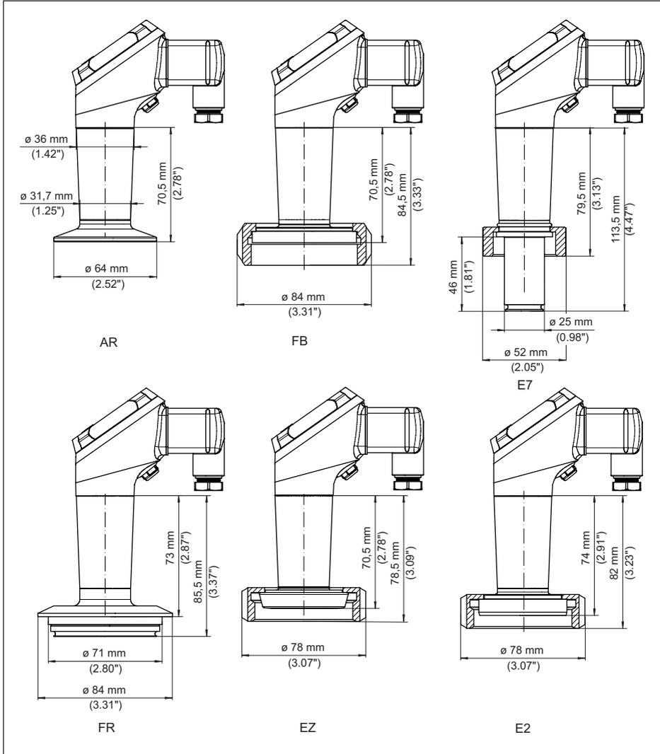
Abb. 39: VEGABAR 39, Hygieneanschluss
