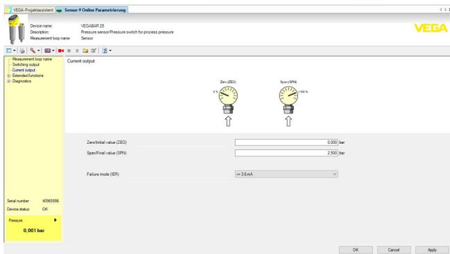
Fig. 28: Exemple de vue DTM - Réglage sortie courant
