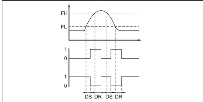
Fig. 24: Effet de la temporisation sur la sortie avec la fonction de fenêtre
