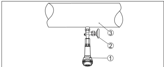
Fig. 10: Mise en œuvre pour la mesure de pression process de liquides dans des conduites
