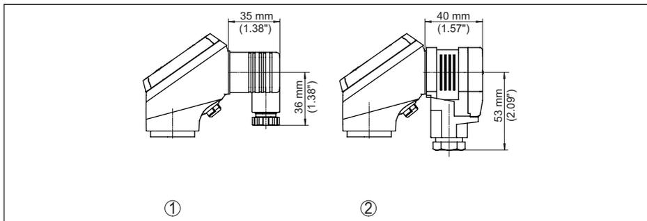
Fig. 34: Technique de raccordement VEGABAR 39
