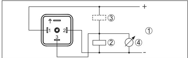
Fig. 17: Schéma de raccordement - trois fils 1 x transistor ou 4 ... 20 mA
