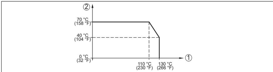
Fig. 32: Derating de température VEGABAR 39
