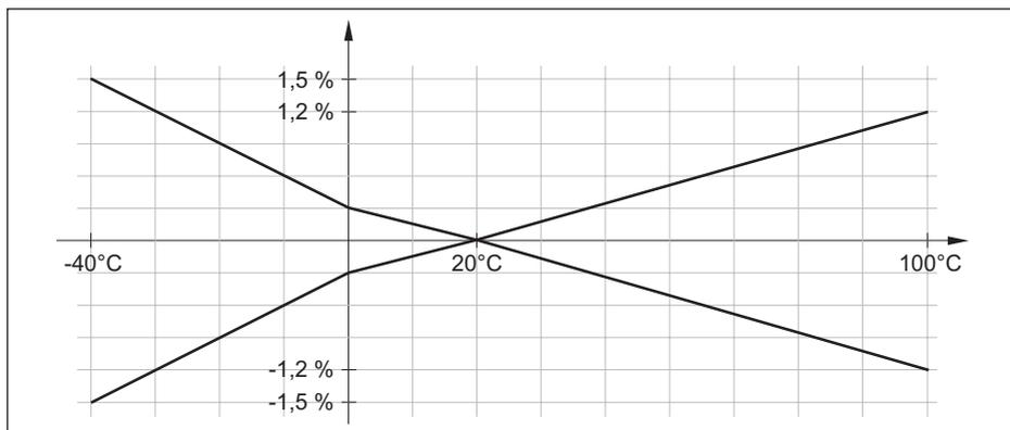
Fig. 31: Erreur de température avec TD 1 : 1
