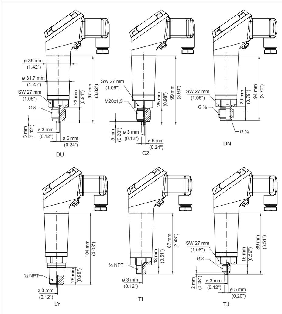
Fig. 35: VEGABAR 39, raccord fileté non arasant
