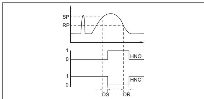
Fig. 23: Effet de la temporisation sur la sortie avec la fonction d'hystérèse
