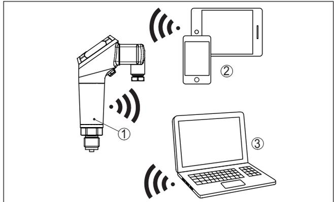
Fig. 5: Connexion sans fil aux unités de réglage standard avec Bluetooth intégré LE
