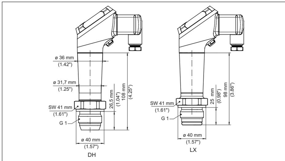
Fig. 37: VEGABAR 39, raccord cône/tube
