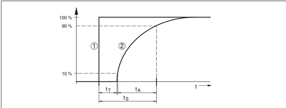
Fig. 30: Comportement du courant de sortie en cas de variation brusque de la grandeur process.  $t_T$  : temps mort ;  $t_A$  : temps de montée ;  $t_S$  : temps de réponse impulsionnelle
