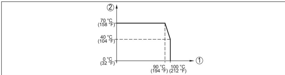
Fig. 33: Derating de température VEGABAR 39, avec la communication Bluetooth activée
