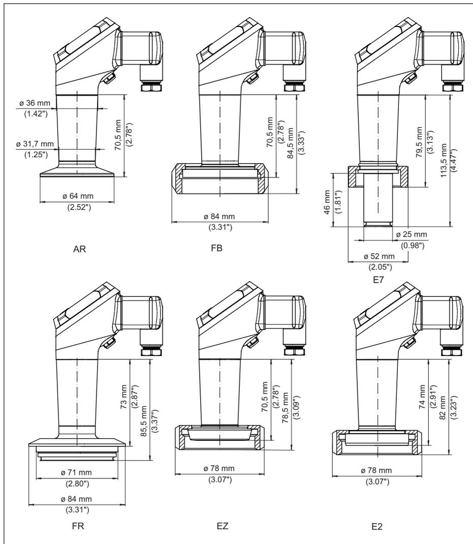
Fig. 38: VEGABAR 39, raccord aseptique
