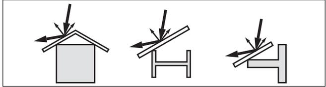
Figura 13: Copertura di profili piatti mediante deflettori
