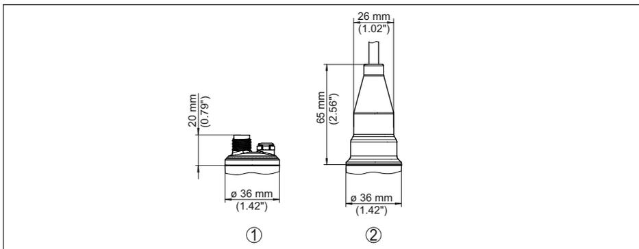
Abb. 24: Anschlussstechnik VEGABAR 29
