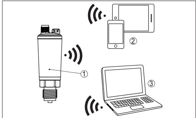
Abb. 6: Drahtlose Verbindung zu Standard-Bedientools mit integriertem Bluetooth LE
