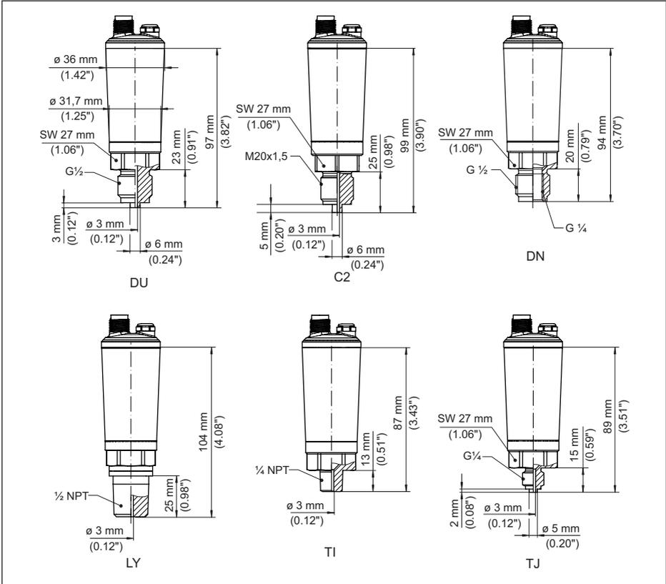
Abb. 25: VEGABAR 29, Gewindeanschluss nicht frontbündig
