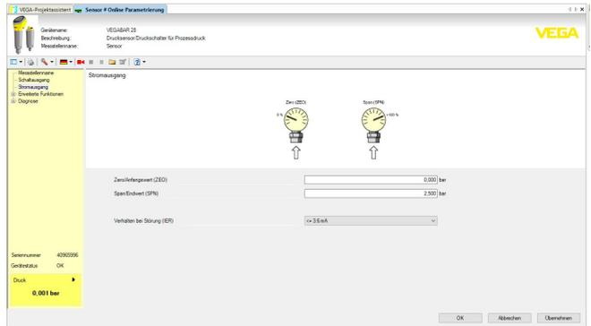
Abb. 18: Beispiel einer DTM-Ansicht - Abgleich Stromausgang
