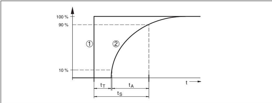
Abb. 20: Verhalten des Stromausganges bei sprunghafter Änderung der Prozessgröße.  $t_T$ : Totzeit;  $t_A$ : Anstiegszeit;  $t_S$ : Sprungantwortzeit
