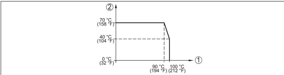
Abb. 23: Temperaturderating VEGABAR 29, bei aktivierter Bluetooth-Kommunikation
