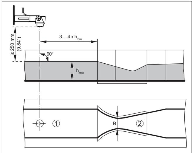
Abb. 18: Durchflussmessung mit Khafagi-Venturirinne:  $h_{max}$  = max. Befüllung der Rinne; B = größte Einschnürung der Rinne
