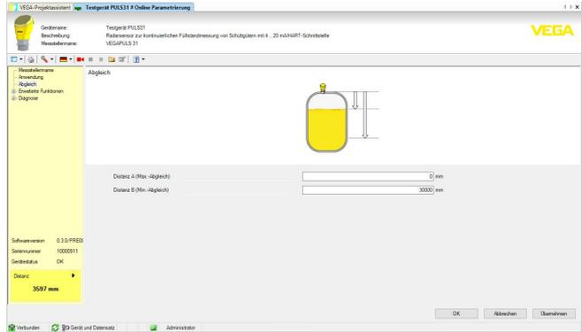
Abb. 26: Beispiel einer DTM-Ansicht
