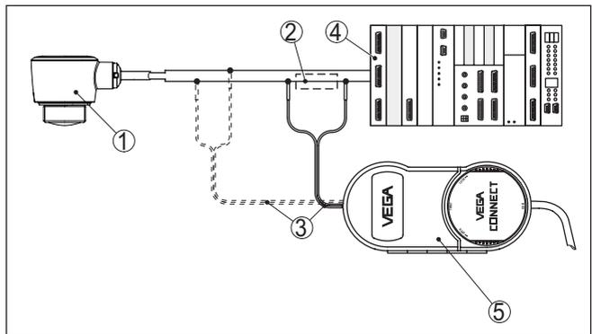
Abb. 4: Anschluss des PCs an die Signalleitung
