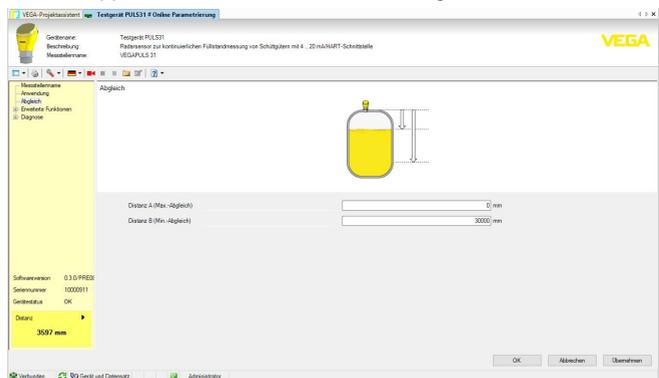
Abb. 23: Beispiel einer DTM-Ansicht - Inbetriebnahme Sensorabgleich
