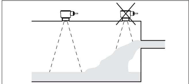
Abb. 11: Montage des Radarsensors bei einströmendem Medium
