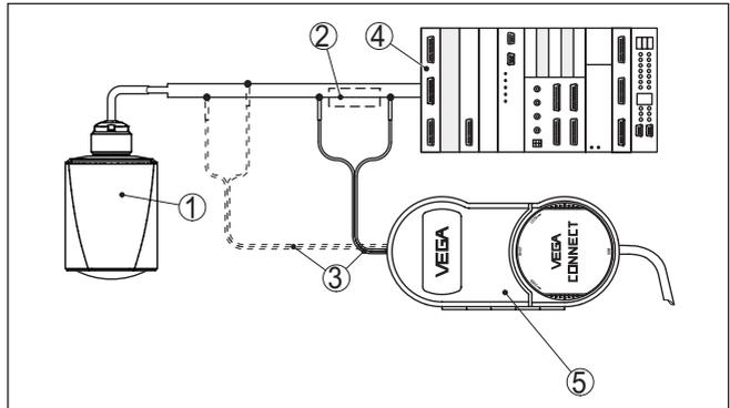
Abb. 3: Anschluss des PCs an die Signalleitung
