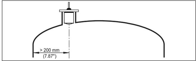
Abb. 6: Montage des Radarsensors an runden Behälterdecken
