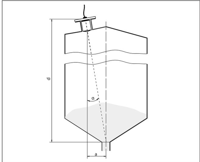
Abb. 15: Vorschlag für den Einbau nach Ausrichtung VEGAPULS C 23
