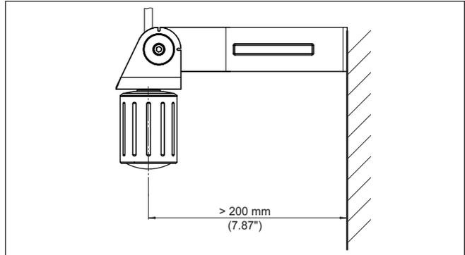
Abb. 4: Montage über einen Montagewinkel
