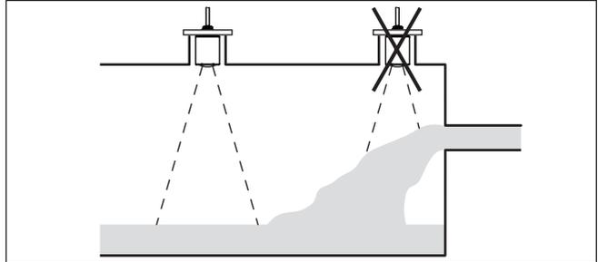
Abb. 9: Montage des Radarsensors bei einströmendem Medium
