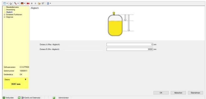
Abb. 23: Beispiel einer DTM-Ansicht - Inbetriebnahme Sensorabgleich
