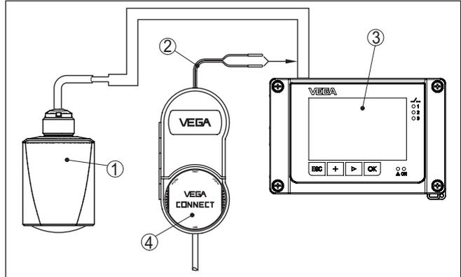
Abb. 25: Anschluss des PCs an das Steuergerät VEGAMET
