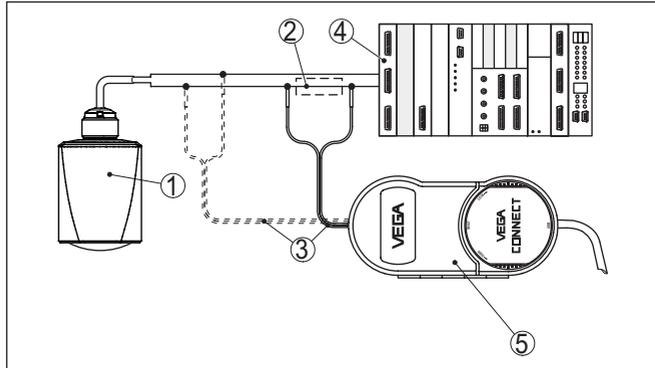
Abb. 24: Anschluss des PCs an die Signalleitung
