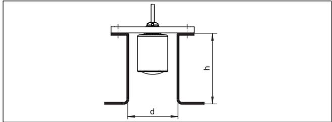
Abb. 11: Rohrstützenmontage bei abweichenden Rohrstützenmaßen
