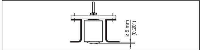
Abb. 10: Empfehlenswerte Rohrstutzenmontage des VEGAPULS C 23
