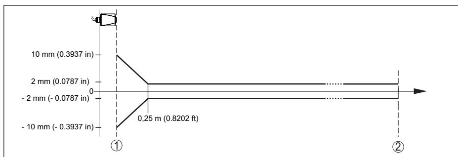
插图. 31: 在基准条件下的测量偏差<sup>10)</sup>
