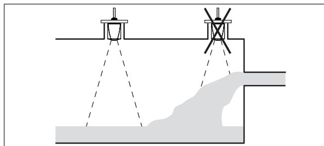
插图. 10: 流入介质时安装雷达传感器
