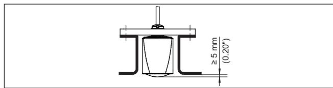
插图. 11: 将 VEGAPULS C 23 安装在管接头上，这种方法值得推荐
