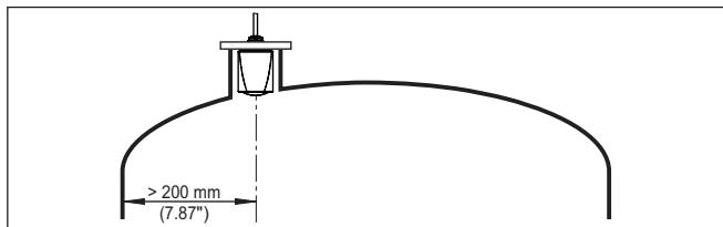
插图. 7: 将雷达传感器安装在圆形容器盖上
