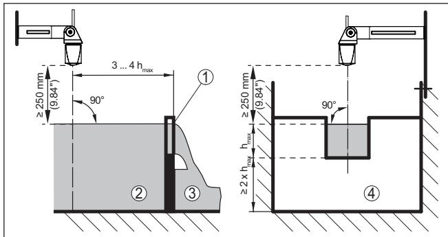
插图. 18: 用矩形槽测量流量 :  $h_{\max}$  = 矩形槽的最大注水高度
