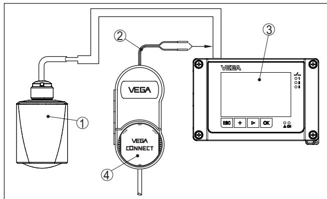
插图. 26: 将电脑与 VEGAMET 型控制器相连接
