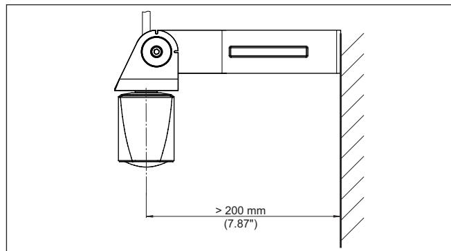
插图. 5: 通过一个安装角形件进行安装
