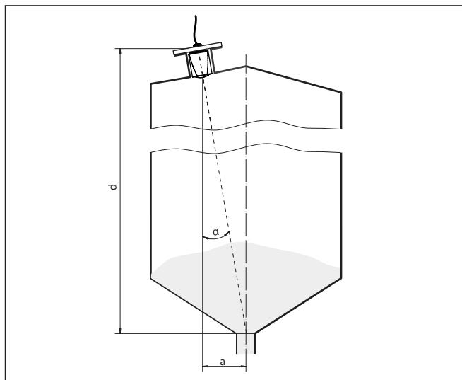
插图. 16: 校准 VEGAPULS C 23 后的安装建议
