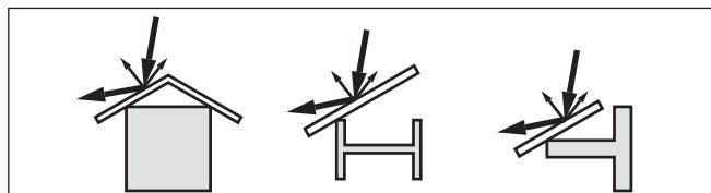
插图. 13: 用散射挡板来覆盖光滑的型材
