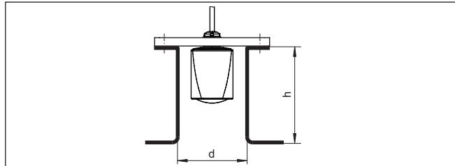
插图. 12: 当管接头的尺寸有别时管接头的安装
