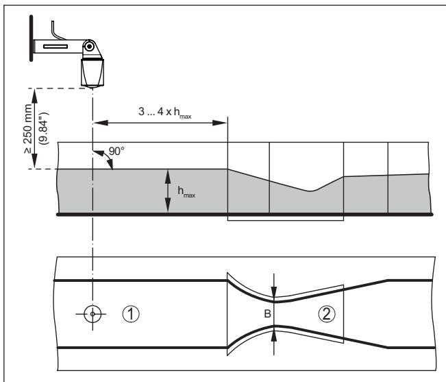
插图. 19: 用卡发基-文丘里槽来测量流量 :  $h_{\max}$  = 水槽的最大灌装量 ; B = 水槽的最大收缩率
