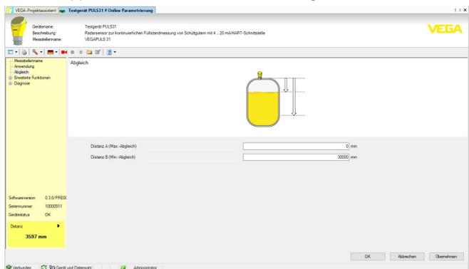
Abb. 22: Beispiel einer DTM-Ansicht - Inbetriebnahme Sensorabgleich
