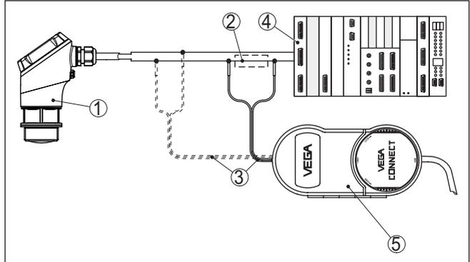
Abb. 23: Anschluss des PCs an die Signalleitung
