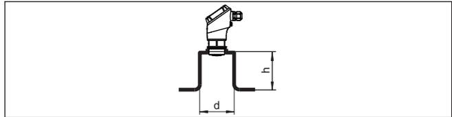
Abb. 11: Rohrstützenmontage
