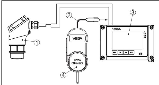
Abb. 24: Anschluss des PCs an das Steuergerät VEGAMET
