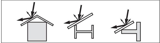
Fig. 12: Tapar los perfiles lisos con pantallas dispersoras
