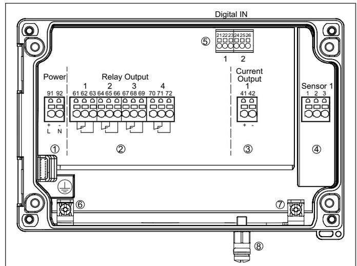
Fig. 8: Wiring plan VEGAMET
