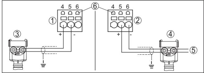
插图. 8: 输入端接口 2, 用于两线制/四线制传感器 (有源/无源)
