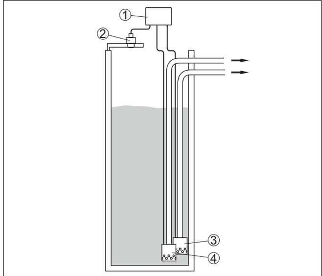
插图. 17: 泵站举例：在流入沟口控制泵
