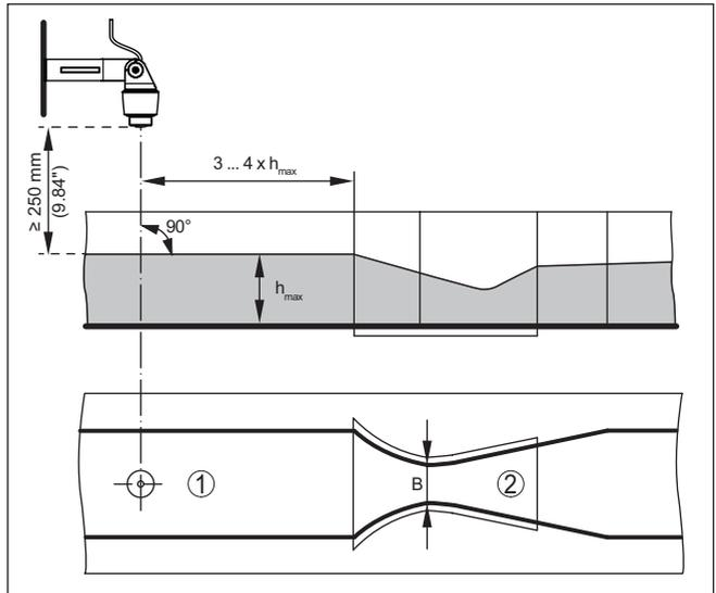
插图. 25: 用卡发基-文丘里槽来测量流量:  $h_{max}$  = 水槽的最大灌装量; B = 水槽的最大收缩率
