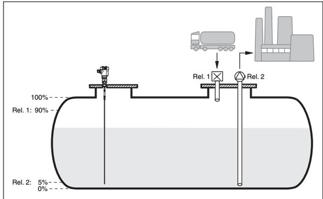
插图. 16: 举例说明对卧式圆形槽罐的物位测量
