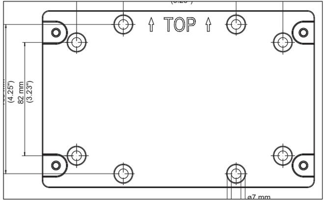
插图. 3: 用于壁挂式安装的安装板 VEGAMET 862
