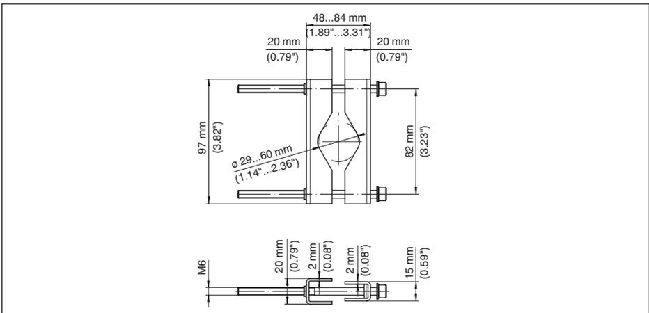
Fig. 29: Dimensions équerres pour le montage sur tuyauterie
