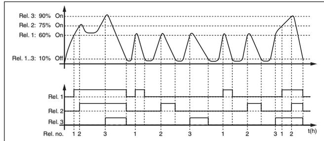
Fig. 21: Exemple pour la commande de pompes 4
