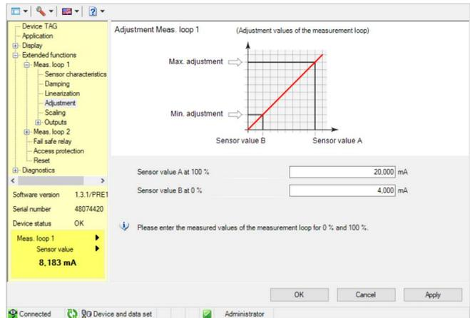
Fig. 15: Exemple de vue DTM - réglage
