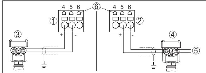
Fig. 8: Raccord entrée 2 pour capteur à deux fils/à quatre fils (actif/passif)
