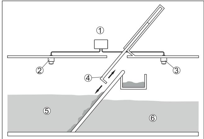
Fig. 23: Exemple de commande de dégrilleur
