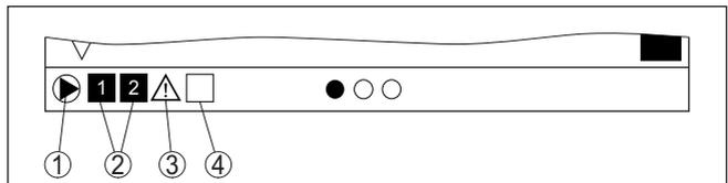
插图. 16: 泵控制激活情况下的显示器状态条举例
