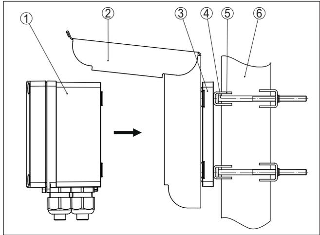
插图. 5: 将遮阳罩安装在管线上
