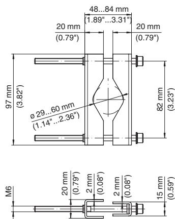
插图. 27: 用于安装在管件上用的夹子尺寸
