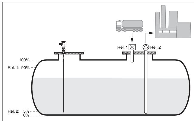
插图. 14: 举例说明对卧式圆形槽罐的物位测量
