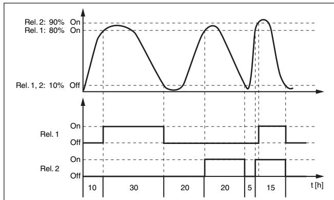
插图. 17: 示例 : 泵控制器 2
