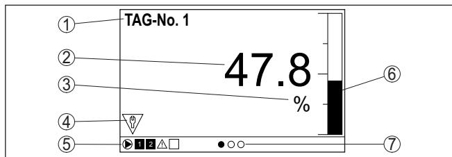
插图. 10: 测量值显示窗口举例 (用柱状图显示测量值)
