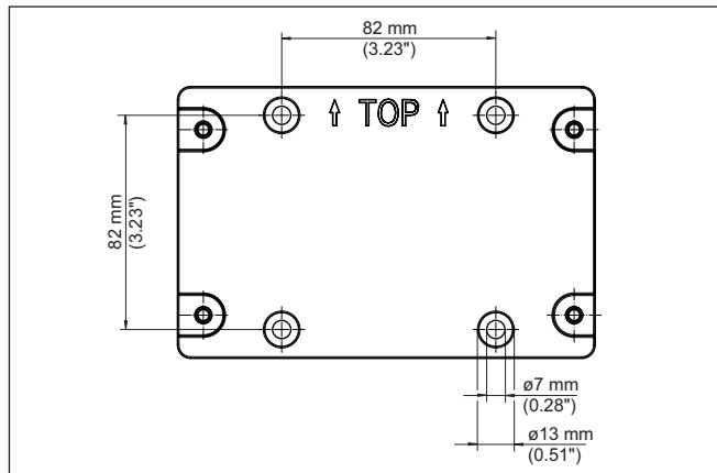
插图. 3: 用于壁挂式安装的安装板 VEGAMET 842
