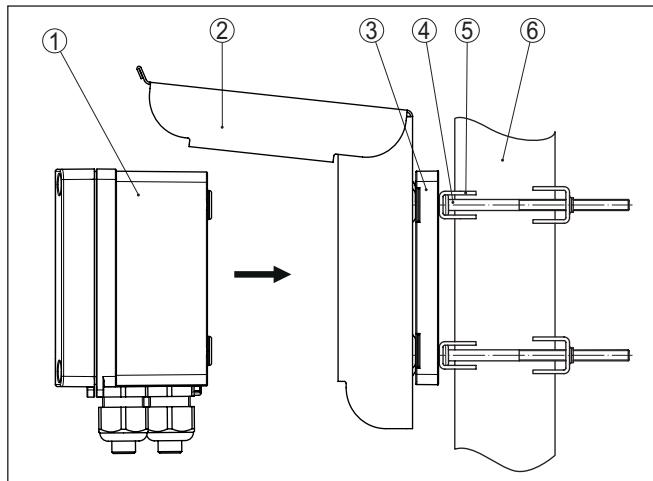
插图. 5: 将遮阳罩安装在管件上
