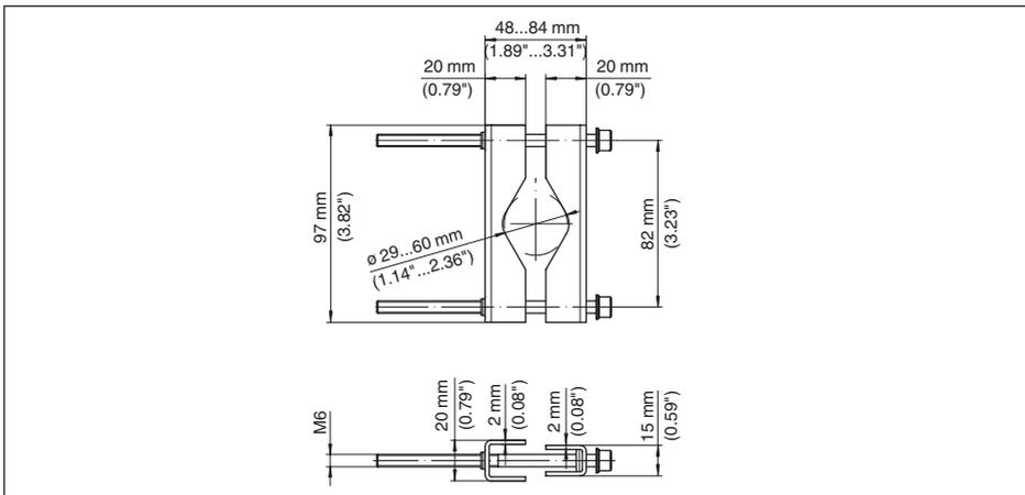
Fig. 27: Dimensions équerres pour le montage sur tuyauterie
