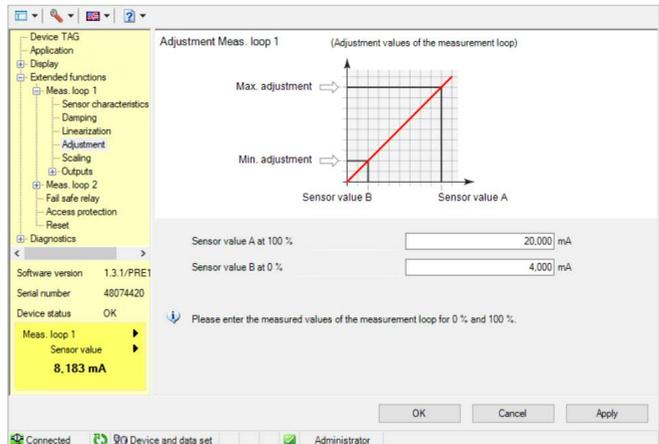
Fig. 13: Exemple de vue DTM - réglage
