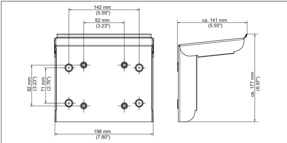
Fig. 26: Dimensions protection solaire
