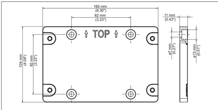
Fig. 25: Dimensions plaque de montage
