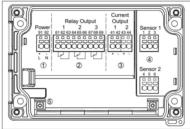
Fig. 6: Schéma de raccordement VEGAMET 842
