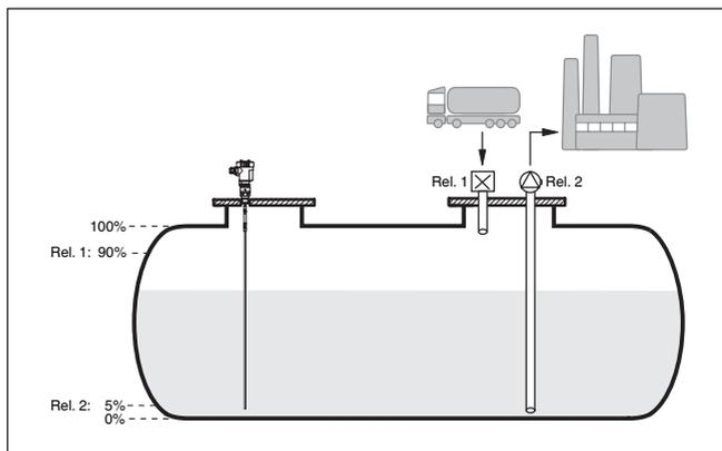
Fig. 14: Exemple de mesure de niveau de cuve cylindrique couchée
