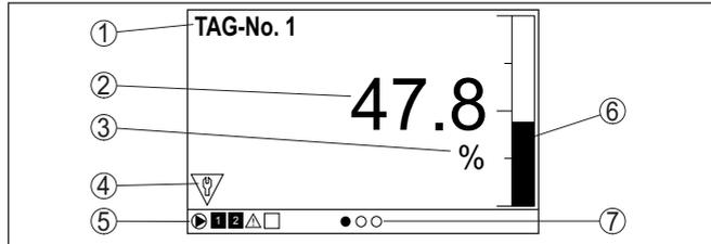
Fig. 10: Exemple affichage des valeurs mesurées (valeur mesurée avec bargraphe)
