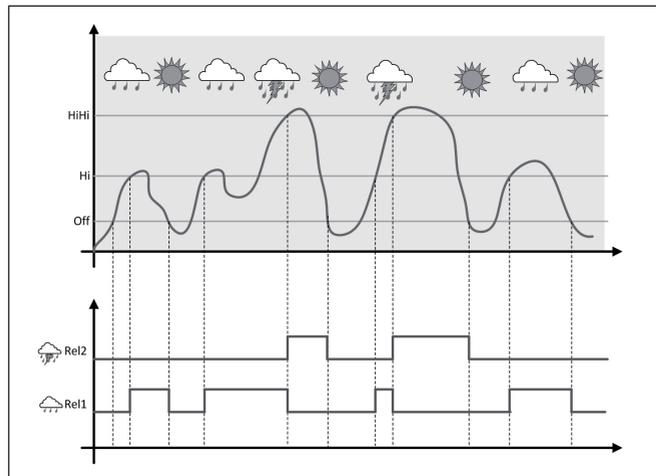
Fig. 18: Exemple d'une commande de pompes avec l'option " Fonctionnement par beau temps"
