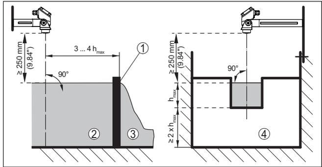
Fig. 22: Mesure du débit avec déversoir rectangulaire:  $h_{max}$  = remplissage max. du déversoir rectangulaire
