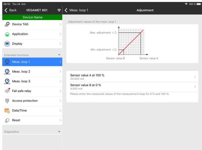
Fig. 12: Exemple de vue de l'appli - Mise en service réglage
