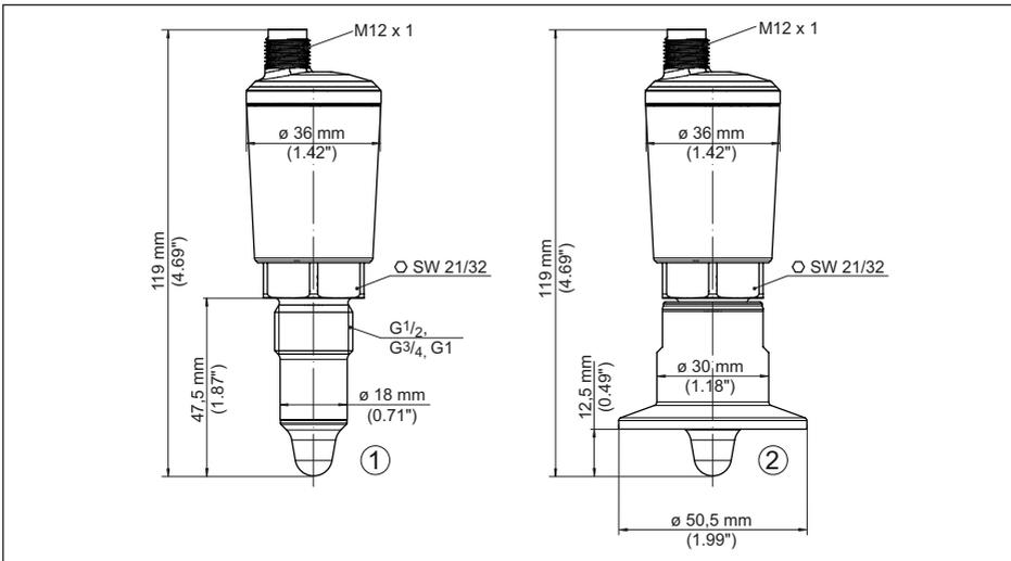
Abb. 15: VEGAPOINT 31, Hygieneausführung - Gewinde, mit M12 x 1-Stecker
