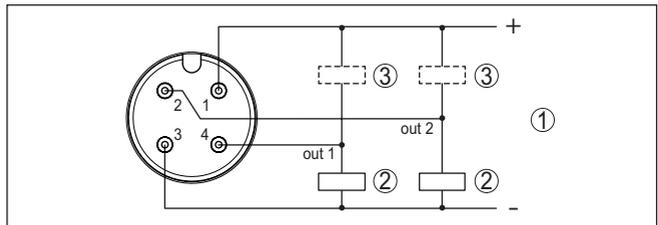
Abb. 6: Anschlussplan M12 x 1-Stecker - Transistorausgang, Dreileiter
