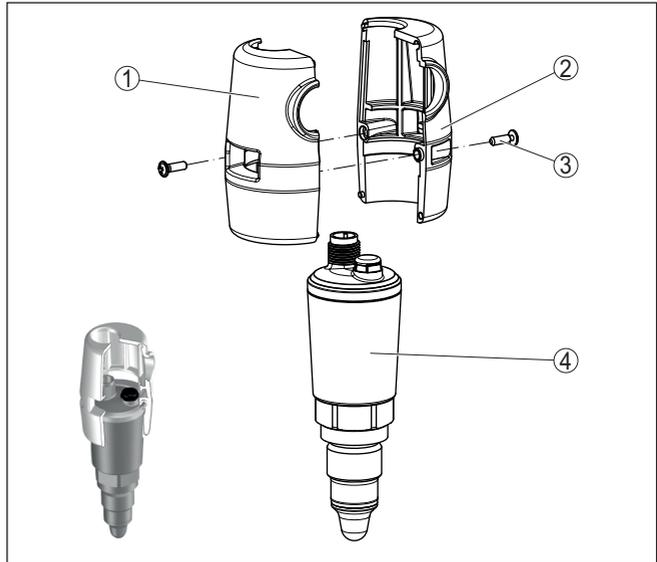
Abb. 4: Montage der Schutzhaube
