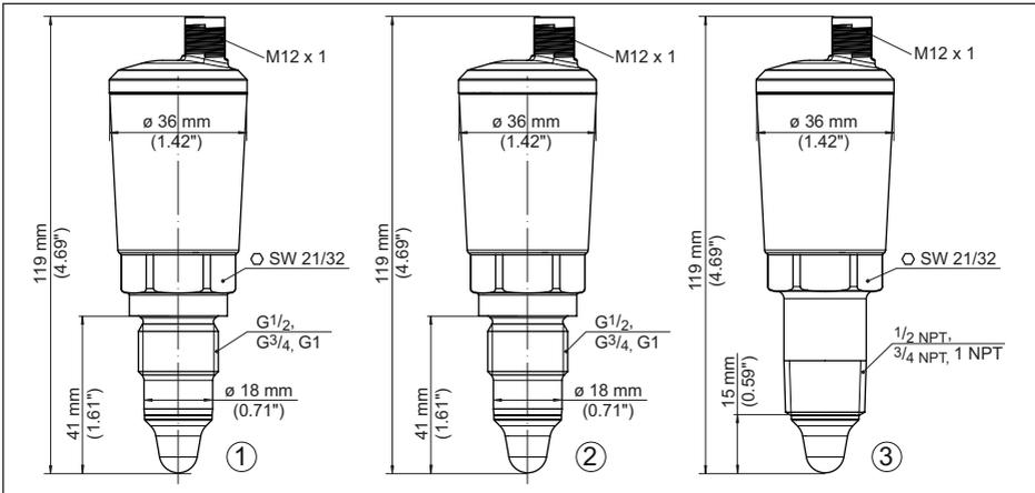
Abb. 14: VEGAPOINT 31, Standardausführung - Gewinde mit M12 x 1-Stecker
