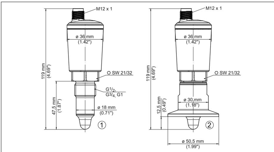
Fig. 15: VEGAPOINT 31, version hygiénique - Filetage, avec connecteur M12 x 1
