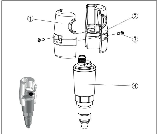
Fig. 4: Montage du capot de protection
