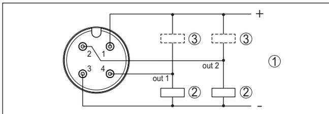
Fig. 6: Plan des connexions connecteur M12 x 1 - Sortie transistor, trois fils
