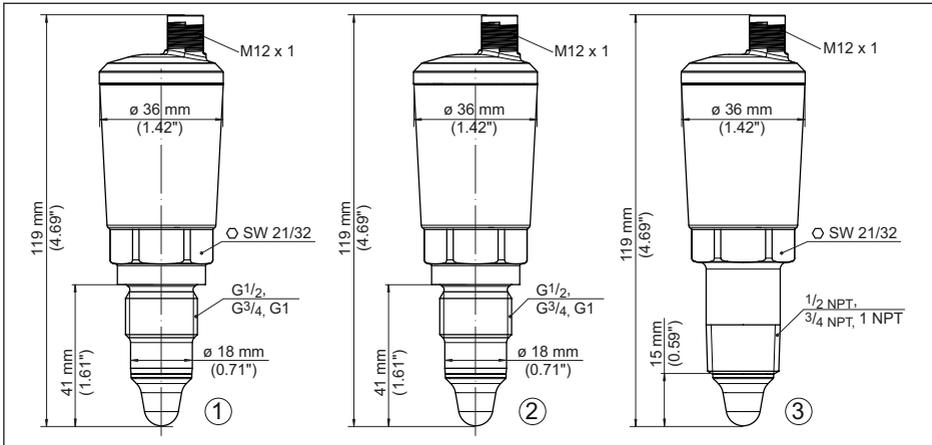
Fig. 14: VEGAPOINT 31, version standard - Filetage avec connecteur M12 x 1
