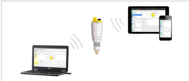
Conexión inalámbrica con dispositivos de control estándar con Bluetooth LE integrado o alternativamente adaptador Bluetooth-USB
