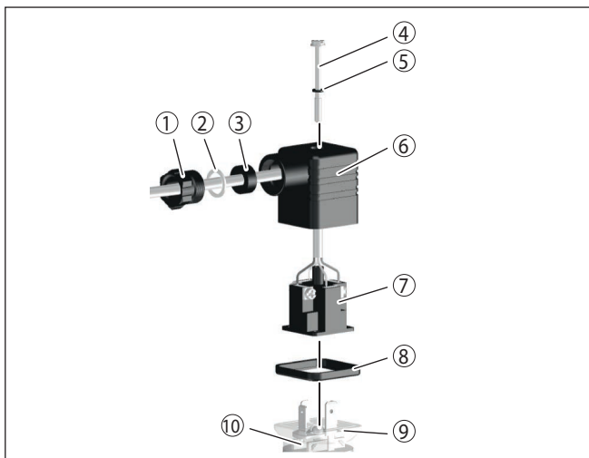
Figura 9: Collegamento del connettore a valvola ISO 4400
