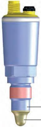
Das Messprinzip basiert auf dem Frequenzhubverfahren. Die PEEK-Spitze (1) sowie das Metallgehäuse (2) bilden einen Teil eines Schwingkreises. Wird die Gerätespitze von einem Medium bedeckt, ändert sich die Frequenz des Schwingkreises. Die Geräteelektronik wertet die Frequenz des Schwingkreises aus und wandelt diese in ein binäres oder ein digitales Ausgangssignal um.
