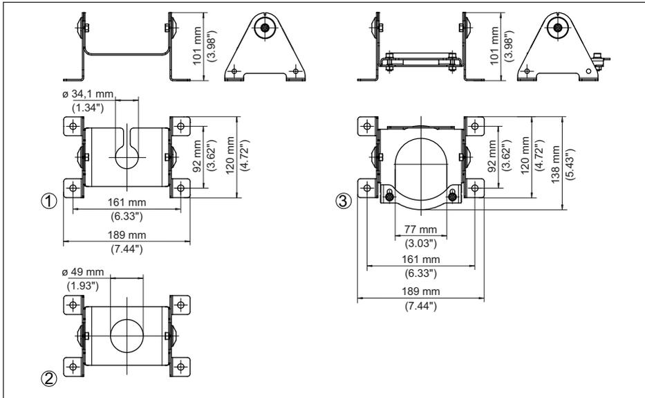
Abb. 28: Montagebügel für Kunststoffbehälter - Standard
