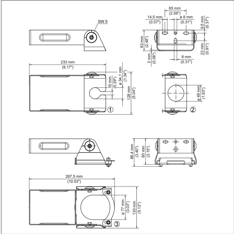
Abb. 23: Montagebügel zur Wandmontage, Sensoraufnahme verstellbar - Ausleger 200 mm
