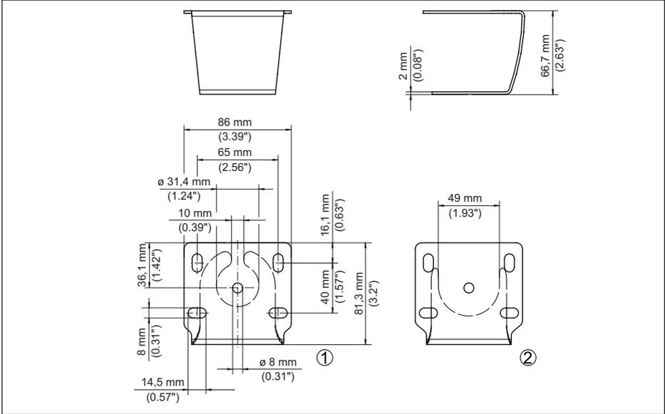
Abb. 20: Montagebügel zur Deckenmontage
