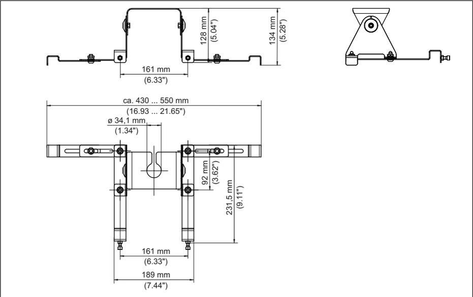
Abb. 29: Montagebügel für Kunststoffbehälter - mit Fixierung für IBC-Behälter, Sensoraufnahme 1"
