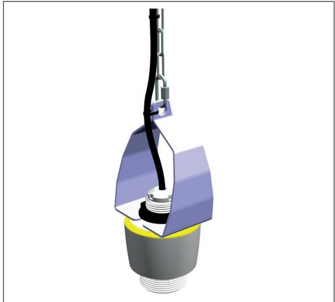
Abb. 7: Montagebügel zur Seil-/Kettenmontage
