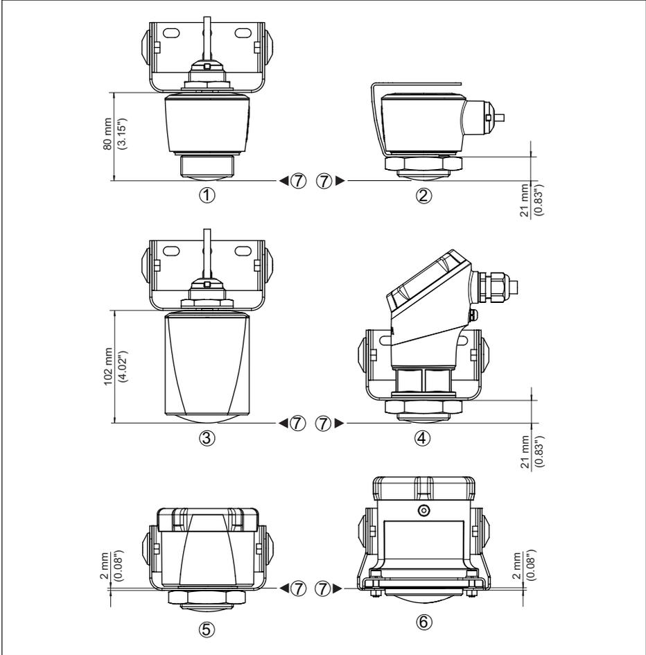
Abb. 32: Montagebügel zur Decken- und Wandmontage - Abstand der Sensorbezugsebene zur Unterseite der Sensoraufnahme
