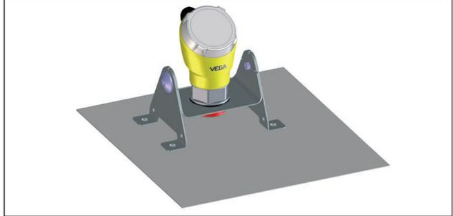
Abb. 15: Montagebügel zur Montage auf Kunststoffbehälter
