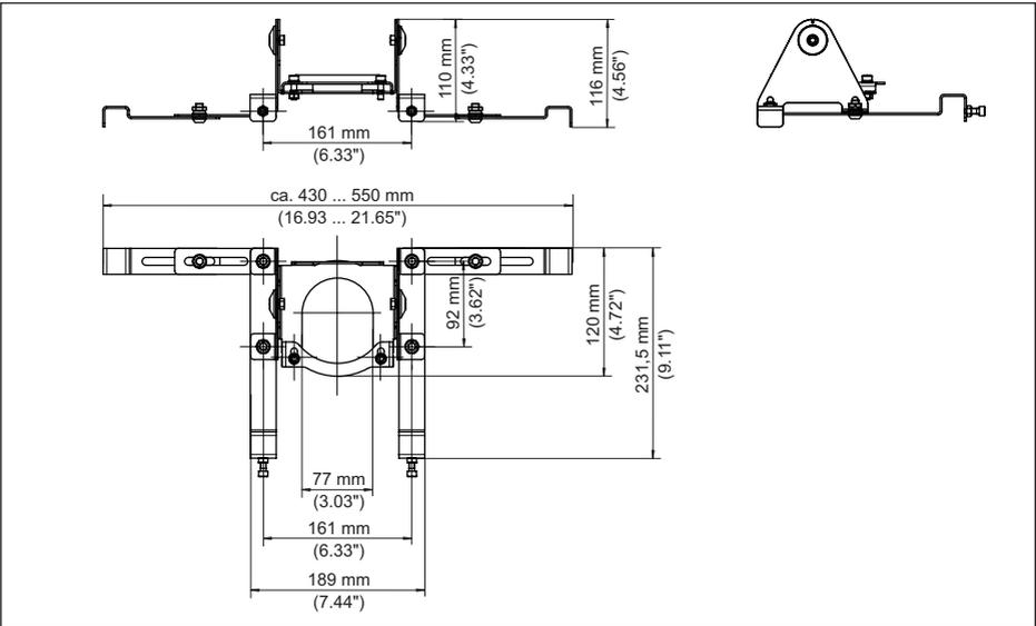
Abb. 30: Montagebügel für Kunststoffbehälter - mit Fixierung für IBC-Behälter, Sensoraufnahme 1½"
