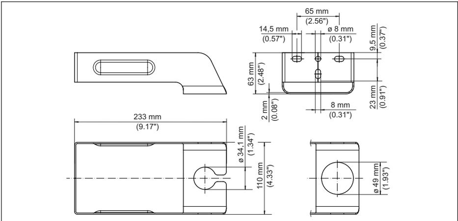
Abb. 21: Montagebügel zur Wandmontage, starr - Ausleger 200 mm
