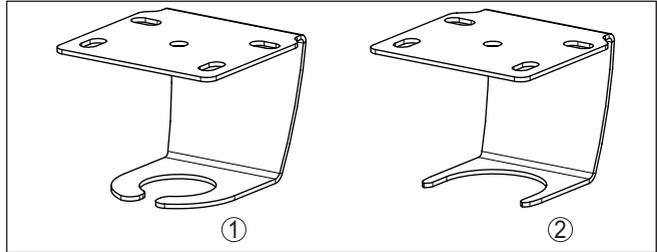
Abb. 2: Montagebügel für Deckenmontage
