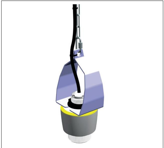
插图. 7: 用于绳/链式安装的龙门框
