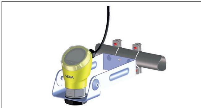
插图. 18: 用于在由承建方提供的管夹上方进行水平管式安装的龙门框
