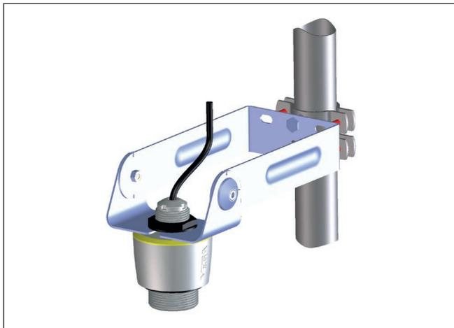
Figura 14: Staffa di montaggio per montaggio su tubo verticale tramite staffe per tubi a cura del cliente
