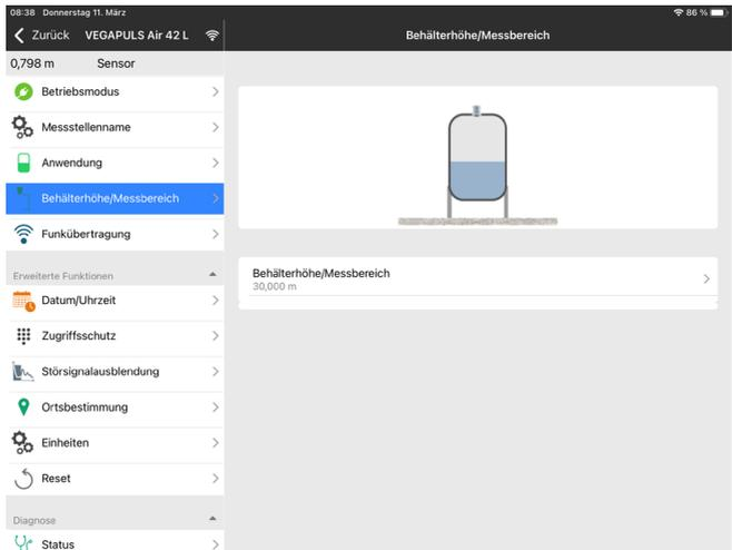
Abb. 22: Beispiel einer App-Ansicht - Menüpunkt Behälterhöhe, Messbereich
