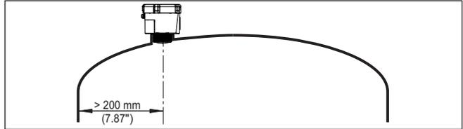
Abb. 6: Montage des Radarsensors an runden Behälterdecken
