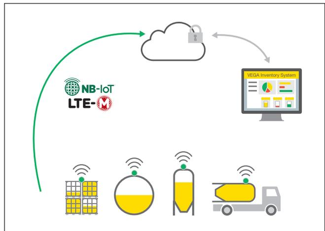
Abb. 3: Drahtlose Messwertübertragung über Mobilfunk
