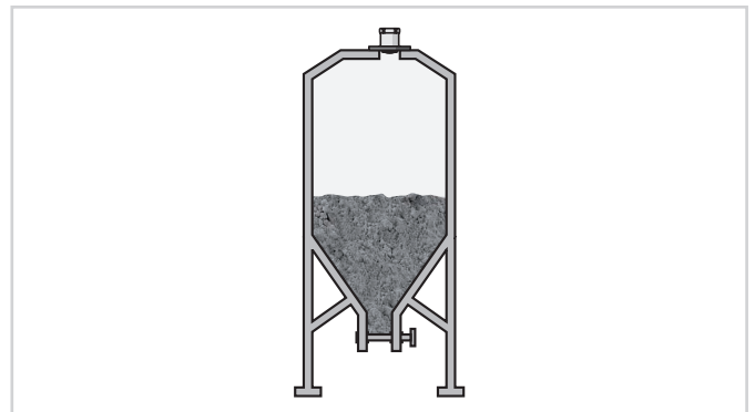
Niveaumeting in bouwstofsilo
