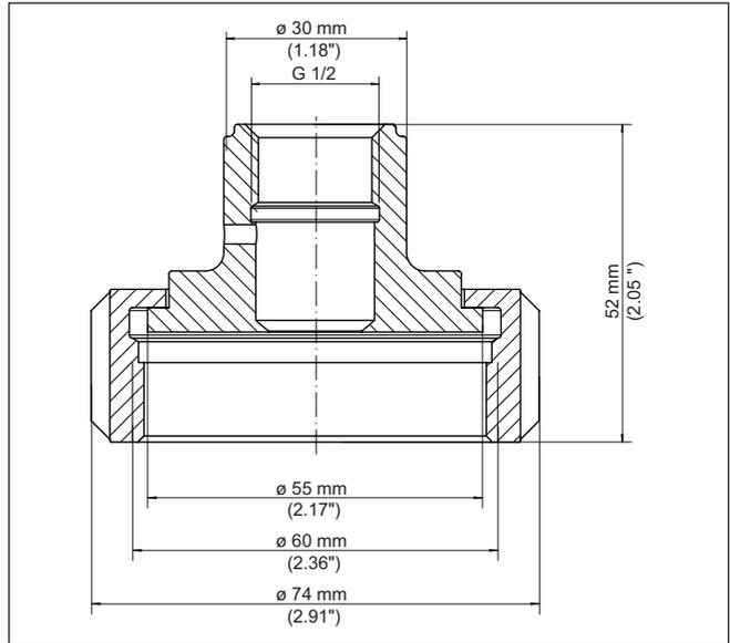
Fig. 84: Dimensiones adaptador higiénico G $\frac{1}{2}$  (DIN 3852-X) a SMS DN 38 - Junta cónica
