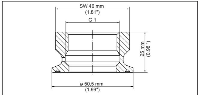
Fig. 47: Dimensiones adaptador higiénico G1 (DIN 3852-X) a Clamp 1½" (DIN 32676, ISO 2852) PN 40 - Junta tórica
