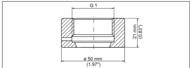
Fig. 41: Dimensiones racor para soldar directo G1 - Junta cónica
