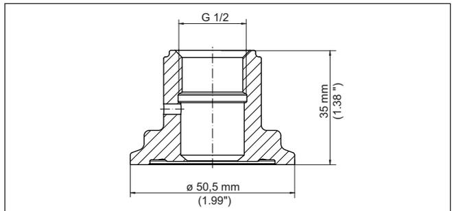
Fig. 79: Dimensiones adaptador higiénico G 1/2 (DIN 3852-X) a racor roscado DN 25 (DIN 11864-3) PN 40 - Junta cónica
