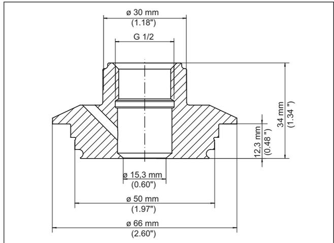
Fig. 83: Dimensiones adaptador higiénico G $\frac{1}{2}$  (DIN 3852-X) a Varivent forma F DN 25 - Junta cónica
