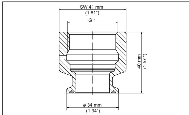
Fig. 46: Dimensiones adaptador higiénico G1 (DIN 3852-X) a brida DN 15-20 (DIN 32676, ISO 2852) PN 40 - Junta tórica
