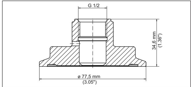
Fig. 81: Dimensiones adaptador higiénico G $\frac{1}{2}$  (DIN 3852-X) a racor roscado DN 50 (DIN 11864-3) PN 40 - Junta cónica
