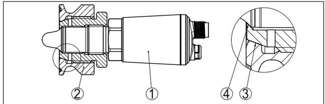
Fig. 38: Junta cónica G1 VEGAPOINT plástico/metal más metal/metal
