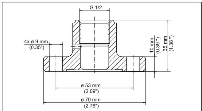
Fig. 76: Dimensiones adaptador higiénico G 1/2 (DIN 3852-X) a racor roscado DN 25 (DIN 11864-2) PN 40 - Junta cónica
