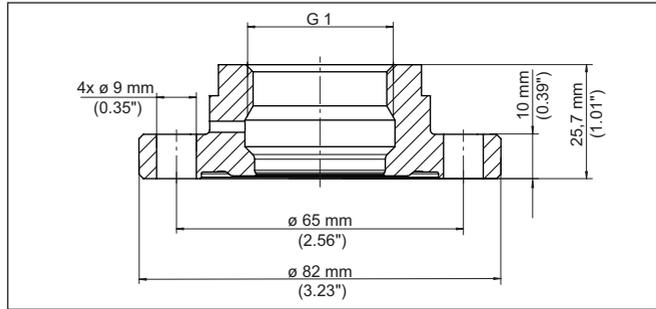
Fig. 57: Dimensiones adaptador higiénico G $\frac{1}{4}$  (DIN 3852-X) a racor roscado DN 40 (DIN 11864-2) PN 40 - Junta tórica
