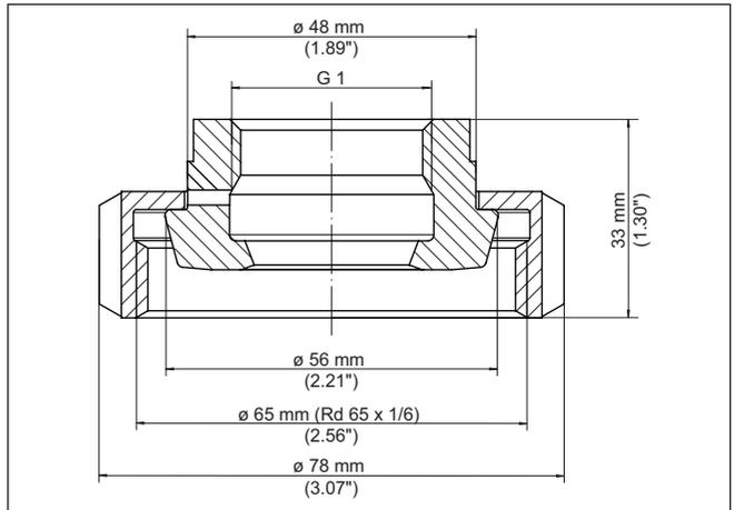
Fig. 50: Dimensiones adaptador higiénico G1 (DIN 3852-X) a racor rosca-
