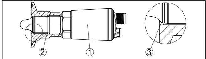
Fig. 67: Junta cónica G $\frac{1}{2}$  VEGAPOINT plástico/metal
