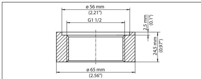
Fig. 10: Dimensiones racor soldado rosca G1½ (DIN 3852-A)
