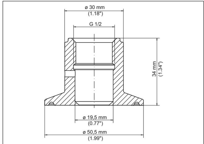
Fig. 69: Dimensiones adaptador higiénico G $\frac{1}{2}$  (DIN 3852-X) a Clamp 1 $\frac{1}{2}$ " (DIN 32676, ISO 2852) PN 40 - Junta cónica
