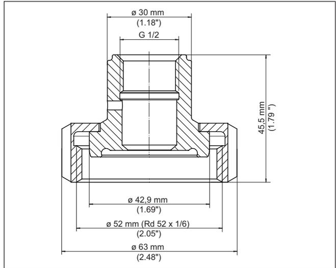
Fig. 73: Dimensiones adaptador higiénico G $\frac{1}{2}$  (DIN 3852-X) a racor roscado DN 25 (DIN 11864-1) PN 40 - Junta cónica
