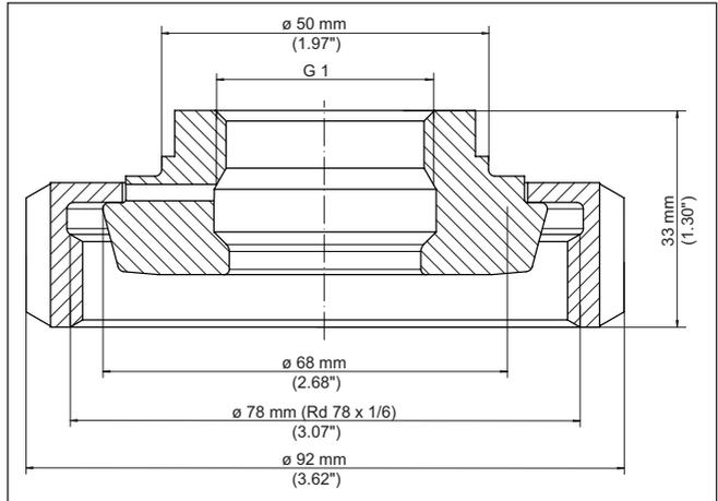
Fig. 52: Dimensiones adaptador higiénico G1 (DIN 3852-X) a racor roscado DN 50 (DIN 11851) PN 40 - Junta tórica
