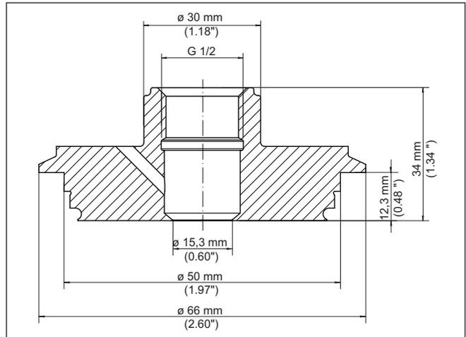
Fig. 82: Dimensiones adaptador higiénico G $\frac{1}{2}$  (DIN 3852-X) a Varivent forma N DN 40 ... DN 100 - Junta cónica
