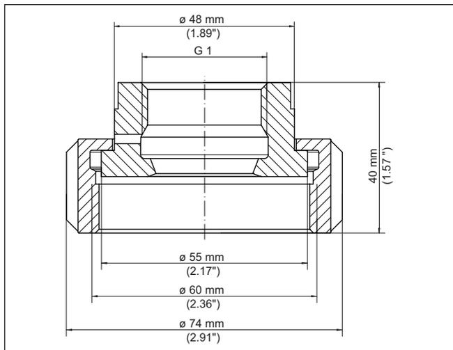
Fig. 65: Dimensiones adaptador higiénico G1 (DIN 3852-X) a SMS DN 38 - Junta cónica
