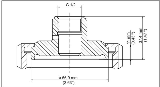
Fig. 75: Dimensiones adaptador higiénico G 1/2 (DIN 3852-X) a racor roscado DN 50 (DIN 11864-1) PN 40 - Junta cónica
