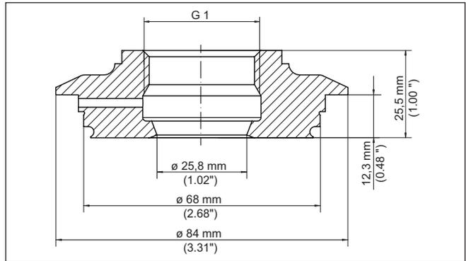
Fig. 62: Dimensiones adaptador higiénico G1 (DIN 3852-X) a Varivent forma N DN 40 ... DN 100 - Junta cónica
