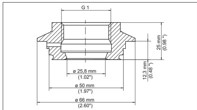
Fig. 61: Dimensiones adaptador higiénico G1 (DIN 3852-X) a Varivent forma F DN 25 - Junta cónica
