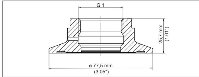
Fig. 60: Dimensiones adaptador higiénico G $\frac{3}{4}$  (DIN 3852-X) a racor roscado DN 50 (DIN 11864-3) PN 25 - Junta tórica
