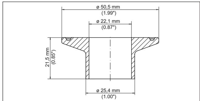
Fig. 30: Medidas racor para soldar Clamp 1" (DIN 32676, ISO 2852)
