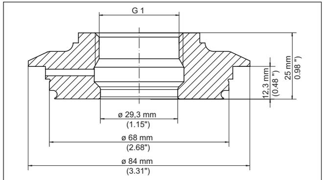
Fig. 64: Dimensiones adaptador higiénico G1 (DIN 3852-X) a Varivent forma N DN 40 ... DN 150 - Junta tórica
