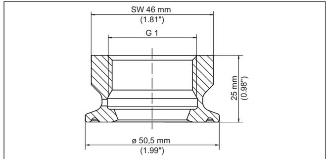
Fig. 44: Dimensiones adaptador higiénico G1 (DIN 3852-X) a Clamp 1½" (DIN 32676, ISO 2852) PN 40 - Junta cónica
