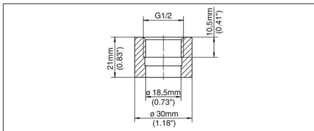
Fig. 5: Dimensiones racor para soldar G $\frac{1}{2}$  (ISO 228-1) frontal rasante - VEGA-BAR 82
