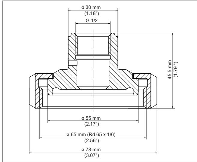
Fig. 74: Dimensiones adaptador higiénico G $\frac{1}{2}$  (DIN 3852-X) a racor roscado DN 40 (DIN 11864-1) PN 40 - Junta cónica
