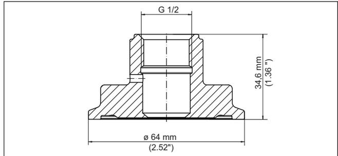
Fig. 80: Dimensiones adaptador higiénico G $\frac{1}{2}$  (DIN 3852-X) a racor rosca-
