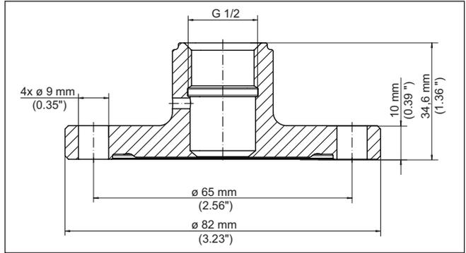
Fig. 78: Dimensiones adaptador higiénico G 1/2 (DIN 3852-X) a racor roscado DN 50 (DIN 11864-2) PN 40 - Junta cónica
