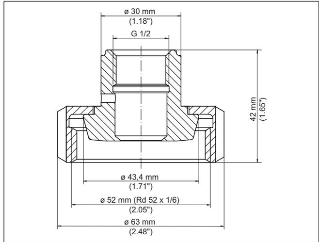
Fig. 71: Dimensiones adaptador higiénico G $\frac{1}{2}$  (DIN 3852-X) a racor roscado DN 25 (DIN 11851) PN 40 - Junta cónica
