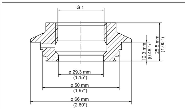
Fig. 63: Dimensiones adaptador higiénico G1 (DIN 3852-X) a Varivent forma F DN 25 - Junta tórica
