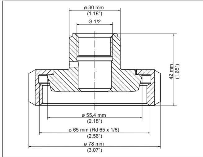
Fig. 72: Dimensiones adaptador higiénico G $\frac{1}{2}$  (DIN 3852-X) a racor roscado DN 40 (DIN 11851) PN 40 - Junta cónica
