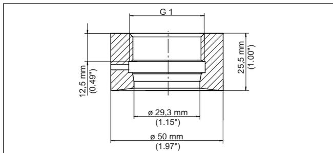
Fig. 9: Dimensiones racor para soldar directo G1 (ISO 228-1) - Junta tórica
