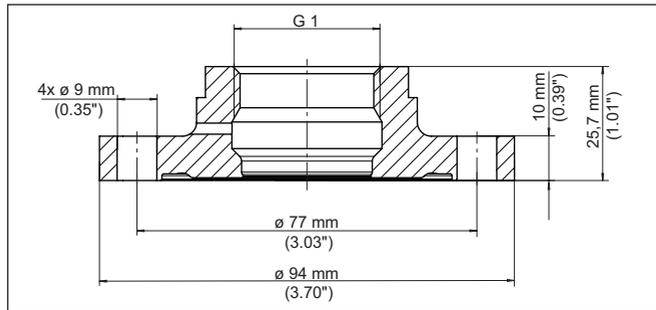
Fig. 58: Dimensiones adaptador higiénico G $\frac{1}{4}$  (DIN 3852-X) a racor roscado DN 50 (DIN 11864-2) PN 25 - Junta tórica
