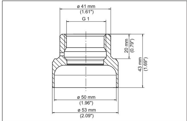
Fig. 29: Dimensiones racor para soldar directo para montaje en tubería G1 (ISO 228-1) - Junta tórica
