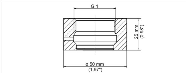
Fig. 43: Dimensiones racor para soldar directo G1 - Junta cónica
