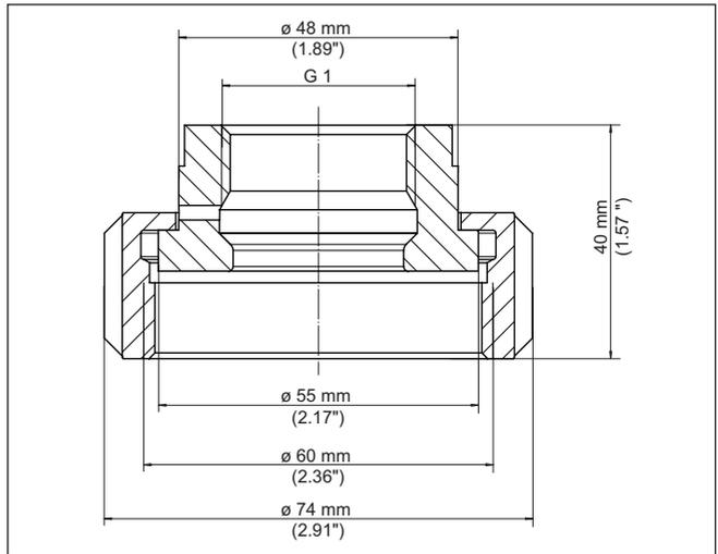
Fig. 66: Dimensiones adaptador higiénico G1 (DIN 3852-X) a SMS DN 38 - Junta tórica
