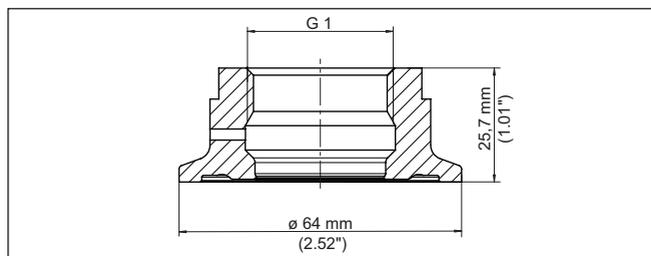
Fig. 59: Dimensiones adaptador higiénico G $\frac{3}{4}$  (DIN 3852-X) a racor roscado DN 40 (DIN 11864-3) PN 40 - Junta tórica
