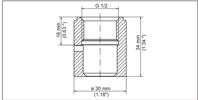
Fig. 68: Dimensiones racor para soldar directo G $\frac{1}{2}$  - Junta cónica
