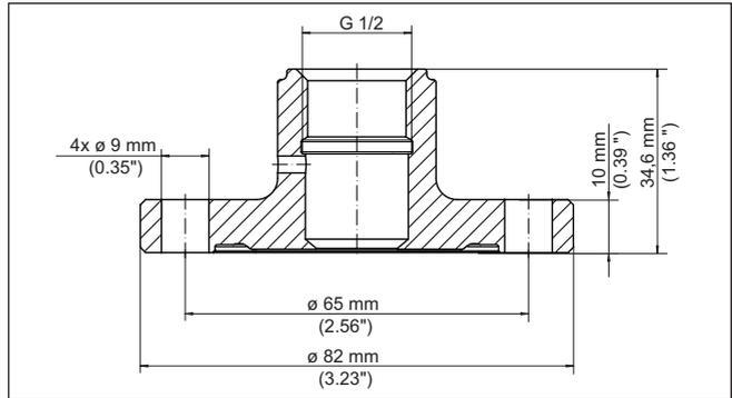
Fig. 77: Dimensiones adaptador higiénico G $\frac{1}{2}$  (DIN 3852-X) a racor rosca-
