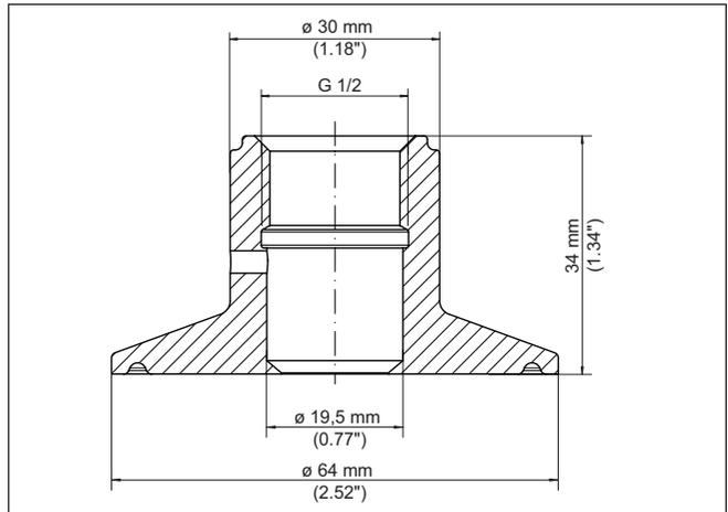
Fig. 70: Dimensiones adaptador higiénico G $\frac{1}{2}$  (DIN 3852-X) a Clamp 2" (DIN 32676, ISO 2852) PN 40 - Junta cónica
