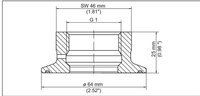
Fig. 48: Dimensiones adaptador higiénico G1 (DIN 3852-X) a Clamp 2" (DIN 32676, ISO 2852) PN 40 - Junta tórica
