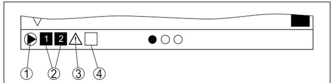
插图. 12: 泵控制激活情况下的显示器状态条距举例
