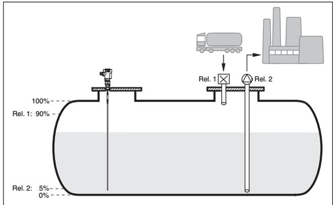
插图. 10: 举例说明对卧式圆形槽罐的物位测量
