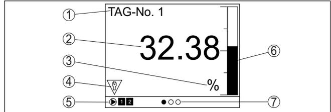
插图. 6: 测量值显示窗口举例 - 用柱状图显示测量值
