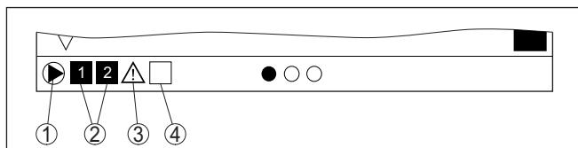
插图. 12: 泵控制激活情况下的显示器状态条举例
