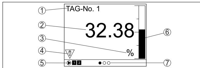
插图. 6: 测量值显示窗口举例 - 用柱状图显示测量值
