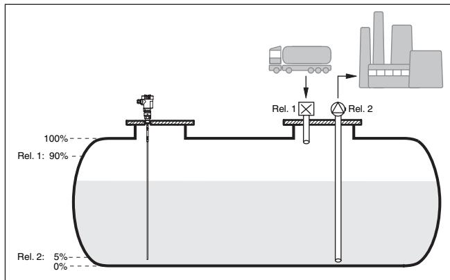
插图. 10: 举例说明对卧式圆形槽罐的物位测量
