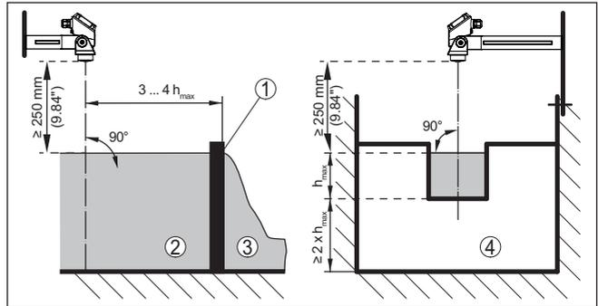
Fig. 17: Medición de caudal con canal rectangular:  $h_{máx.}$  = llenado máx. del canal rectangular
