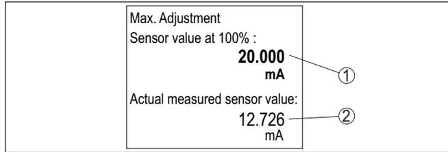
Fig. 7: Ejemplo de vista de un punto de menú - ajuste máximo
