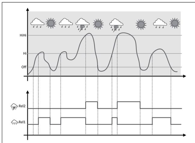
Fig. 14: Ejemplo de un control de bombas con la opción "Operación de buen tiempo"
