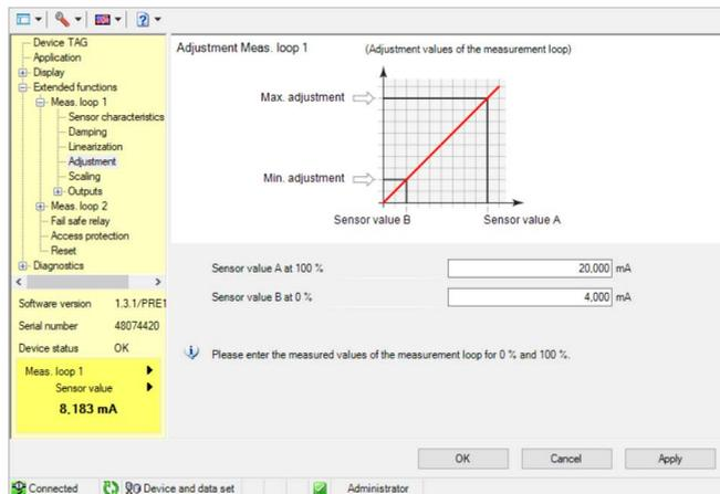
Figura 10: Esempio di schermata DTM - Taratura
