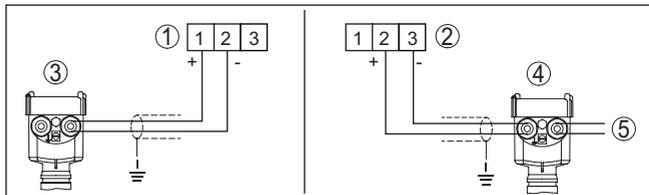
Figura 4: Collegamento ingresso sensore per sensore bifilare/quadrifilare (attivo/passivo)
