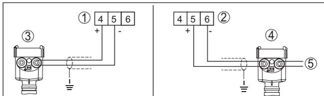
Figura 5: Collegamento ingresso sensore 2 per sensore bifilare/quadrifilare (attivo/passivo)
