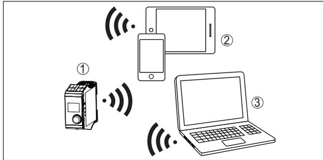
Figura 2: Collegamento wireless a tool di calibrazione standard con Bluetooth LE integrato o alternativemente adattatore USB Bluetooth
