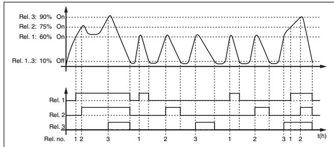
Fig. 17: Ejemplo de control de bomba 4
