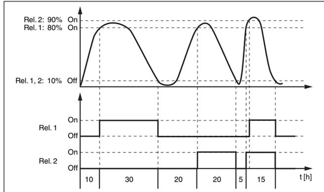
Fig. 15: Ejemplo para el control de bomba 2
