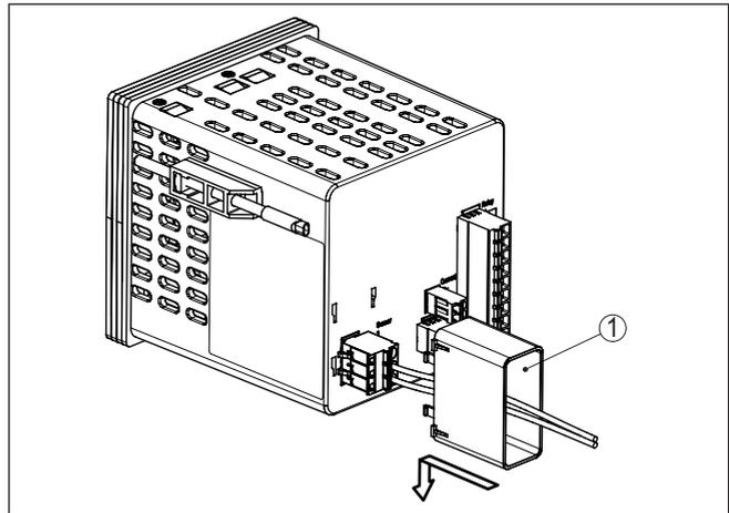
Fig. 6: Montaje de la cámara de separación Ex
