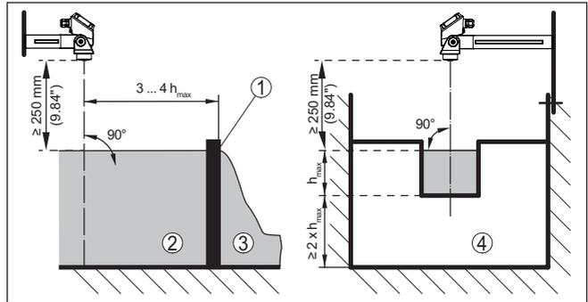
Fig. 19: Medición de caudal con canal rectangular:  $h_{m\acute{a}x}$  = llenado máx. del canal rectangular
