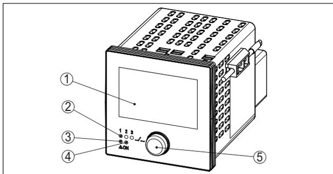
Fig. 7: Elementos de indicación y ajuste
