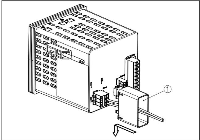
Fig. 7: Montaje de la cámara de separación Ex
