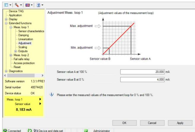
Fig. 12: Ejemplo de una vista DTM - Ajuste
