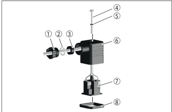
Abb. 9: Anschluss Ventilstecker ISO 4400
