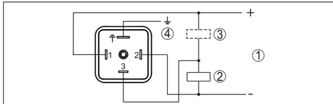
Abb. 13: Anschlussplan Stecker ISO 4400 - Transistorausgang Dreileiter
