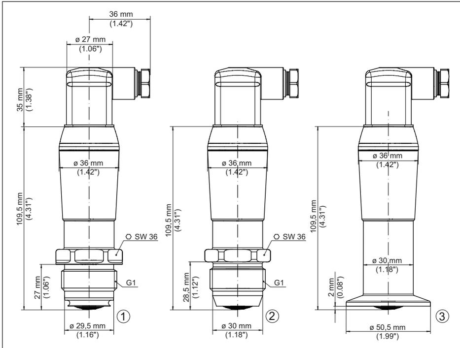
Abb. 21: VEGAPOINT 24, Hygieneausführung - Gewinde mit ISO 4400-Stecker
