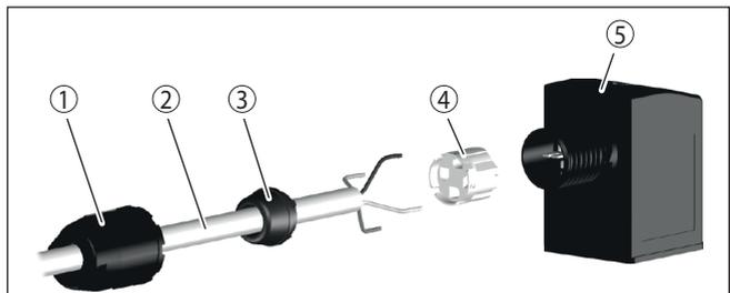
Abb. 10: Anschluss Ventilstecker ISO 4400 mit Schneidklemmtechnik
