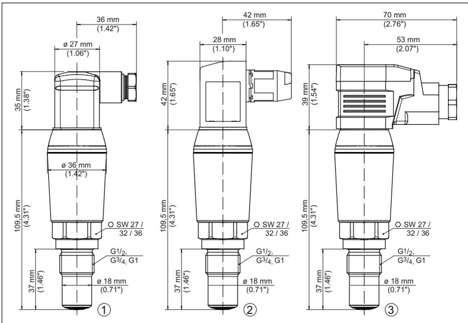
Abb. 20: VEGAPOINT 24, Standardausführung - Gewinde mit Ventilsteckern nach ISO 4400
