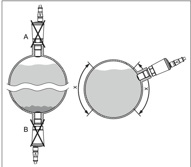
Abb. 6: Montage in waagerechten Rohrleitungen
