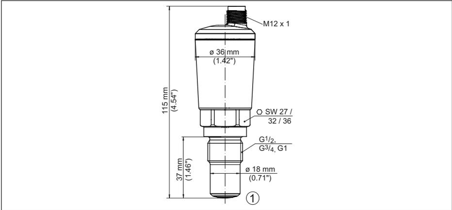
Abb. 16: VEGAPOINT 24, Standardausführung - Gewinde mit M12 x 1-Stecker
