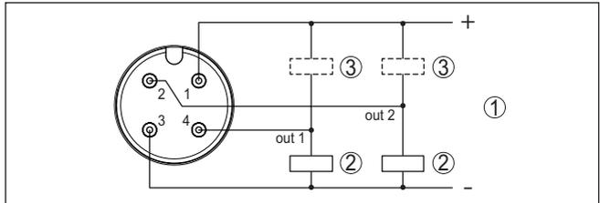
Abb. 9: Anschlussplan M12 x 1-Stecker - Transistorausgang, Dreileiter
