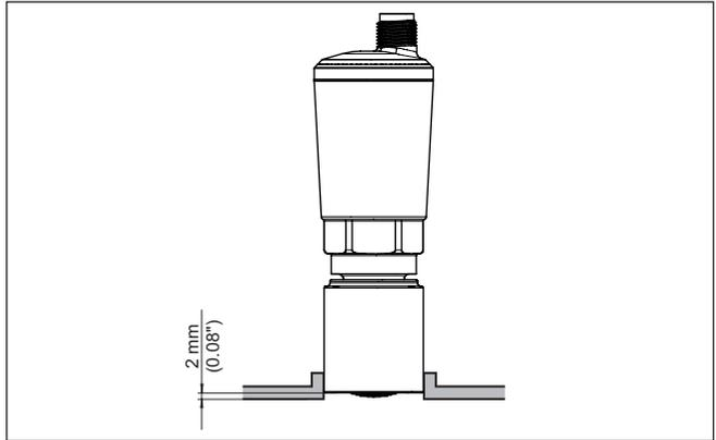
Abb. 7: VEGAPOINT 24 2 mm (0.08 in) rückgesetzt in Lebensmittelanwendung
