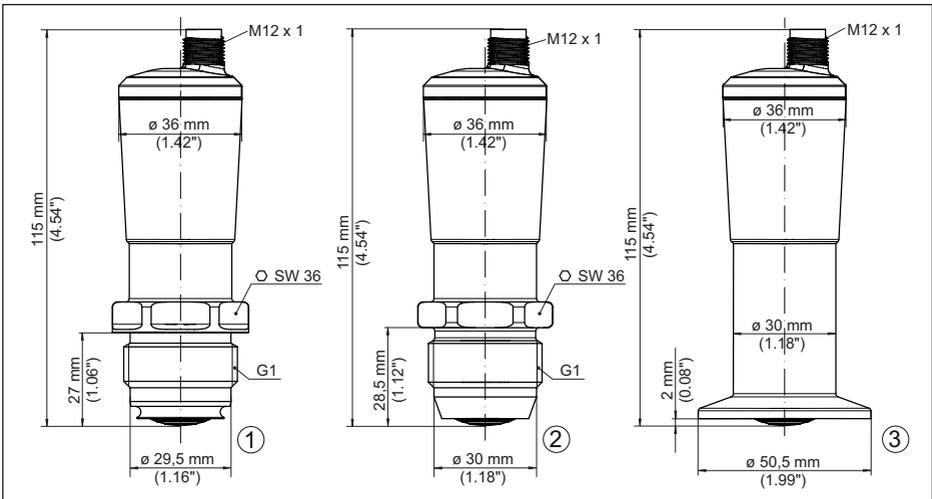
Abb. 17: VEGAPOINT 24, Hygieneausführung - Gewinde, mit M12 x 1-Stecker
