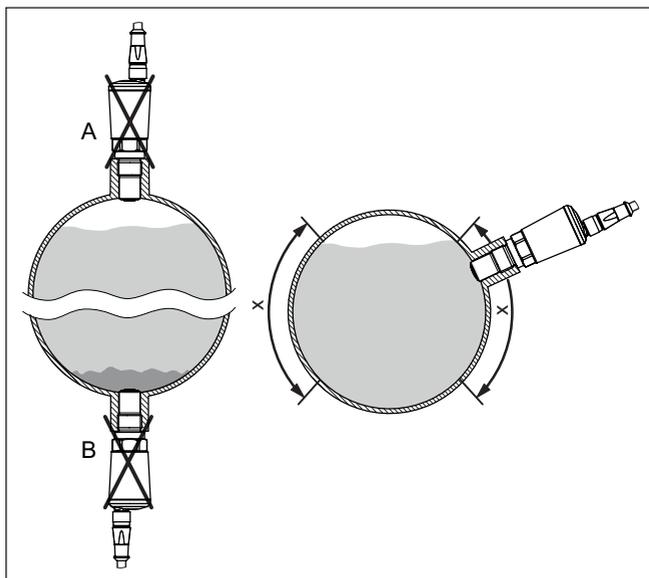
Fig. 5: Montage dans les conduites tubulaires horizontales
