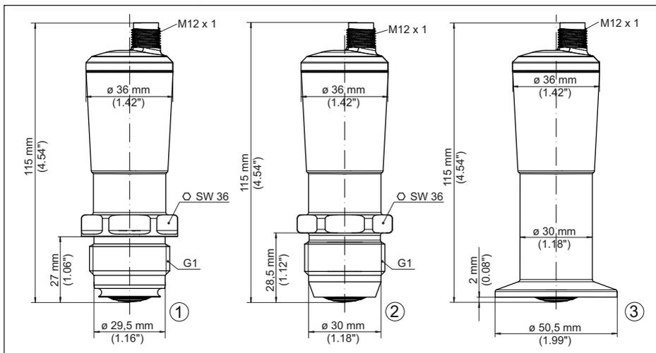
Fig. 16: VEGAPOINT 24, version hygiénique - Filetage, avec connecteur M12 x 1
