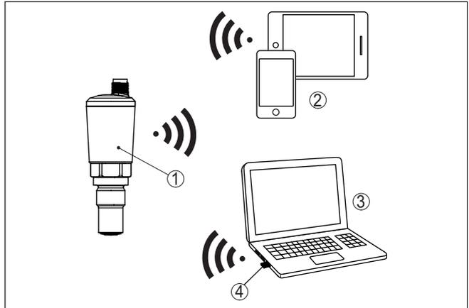
Fig. 2: Connexion sans fil aux appareils de réglage standard avec Bluetooth LE intégré ou en alternative avec un adaptateur Bluetooth-USB
