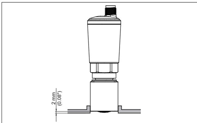
Fig. 6: VEGAPOINT 24 2 mm (0.08 in) décalé vers l'arrière pour les applications alimentaires
