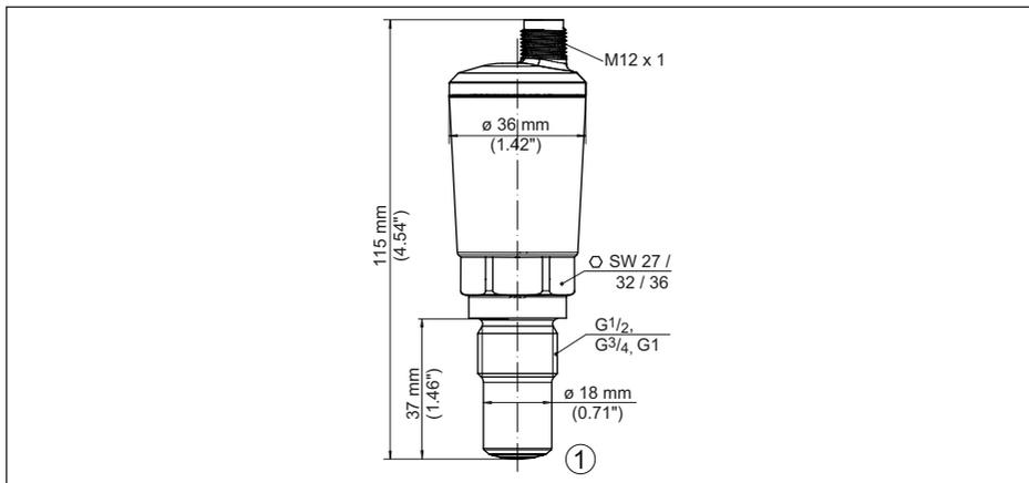
Fig. 15: VEGAPOINT 24, version standard - Filetage avec connecteur M12 x 1
