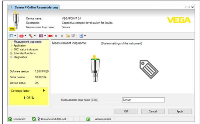
Fig. 13: Exemple d'une vue DTM - Mise en service
