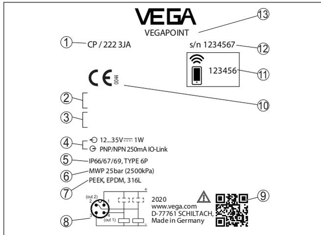
Fig. 2: Présentation de la plaque signalétique (exemple)
