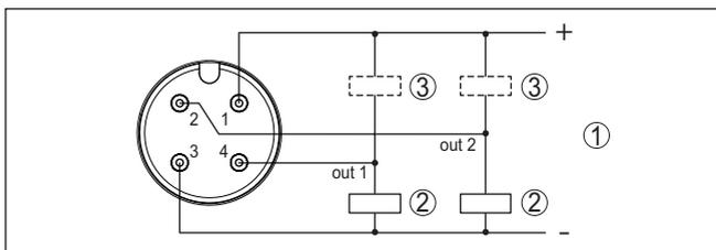
Fig. 9: Plan des connexions connecteur M12 x 1 - Sortie transistor, trois fils
