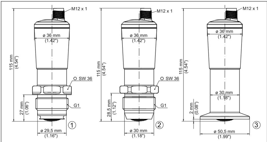
Fig. 17: VEGAPOINT 24, version hygiénique - Filetage, avec connecteur M12 x 1
