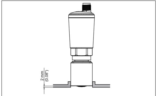
*Fig. 7: VEGAPOINT 24 2 mm (0.08 in) décalé vers l'arrière pour les applications alimentaires*
