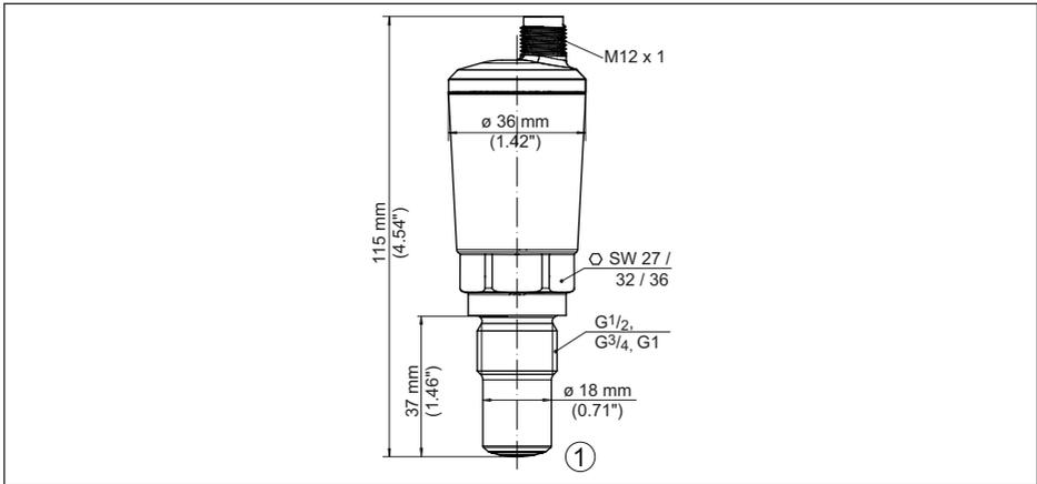
Fig. 16: VEGAPOINT 24, version standard - Filetage avec connecteur M12 x 1
