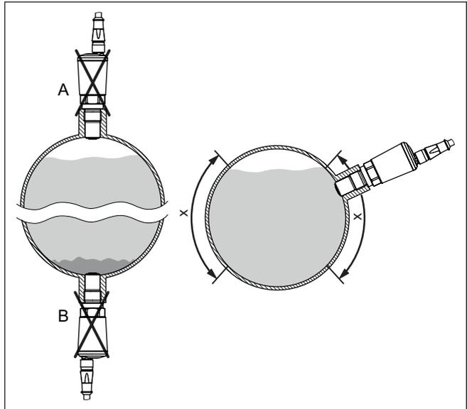
Figura 6: Montaggio in tubazioni orizzontali
