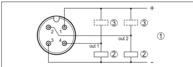
Figura 9: Schema di collegamento connettore M12 x 1 - uscita a transistor, trifilare
