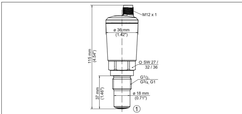
Figura 16: VEGAPOINT 24, esecuzione standard - filettatura con connettore M12 x 1
