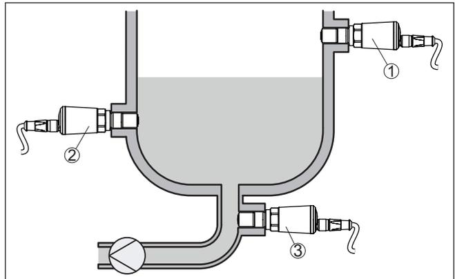
Figura 4: Esempi di montaggio
