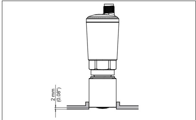
*Figura 7: VEGAPOINT 24 spostato indietro di 2 mm (0.08 in) in un'applicazione nel settore alimentare*
