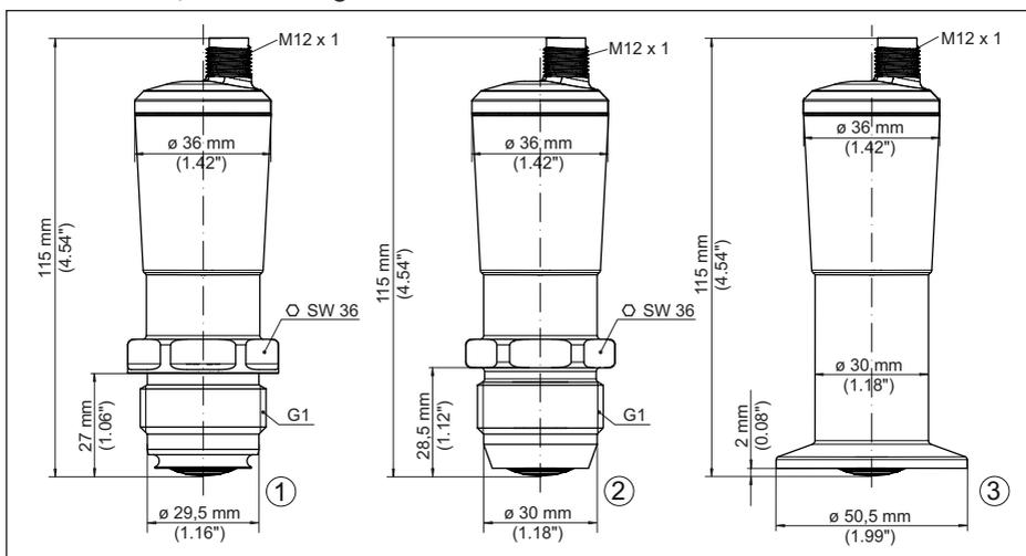
Figura 17: VEGAPOINT 24, esecuzione igienica - filettatura, con connettore M12 x 1
