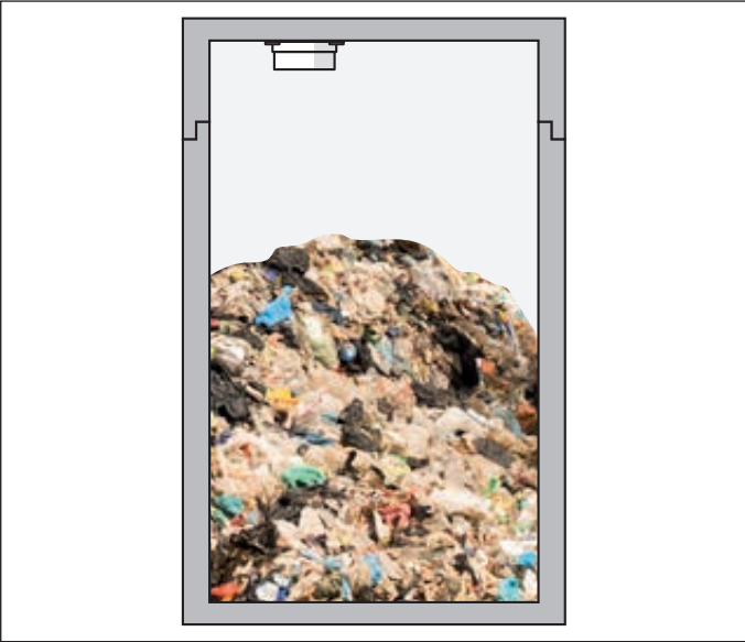
Res. 13: Çöp kabı içinde VEGAPULS Air 23 ile seviye ölçümü
